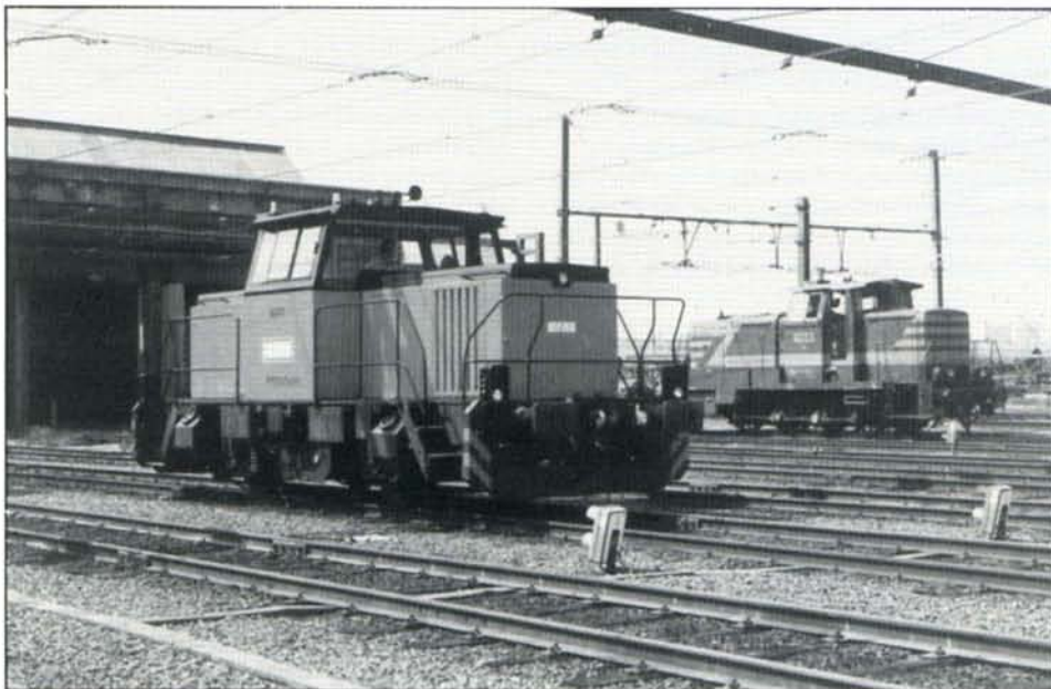
PHOTO 16-47 Gros plan sur la 8070. Le capot avant renferme notamment le groupe de refroidissement du moteur diesel et le compresseur. Atelier de Schaerbeek, 18 août 1993. Photo : Jean-Luc VANDERHAEGEN.
