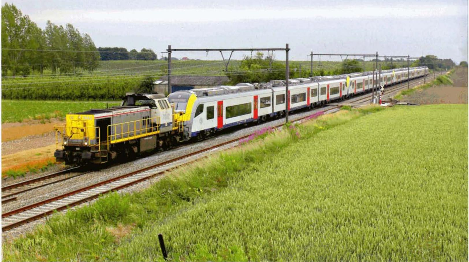
↑ **PHOTO 105-29** Après des essais sous 25 kV entre Bertrix et Virton, quatre automotrices Desiro ont été transférées vers Leuven pour des essais de nuit sur la ligne 36N. Le 25 juin, passage à Beuzet sur la ligne 161 de la 7842 emmenant dans l'ordre les 08503, 08502, 08504 et 08501, soit les quatre Desiro 3 kV / 25 kV actuellement construites. Christian AUQUIERE.
