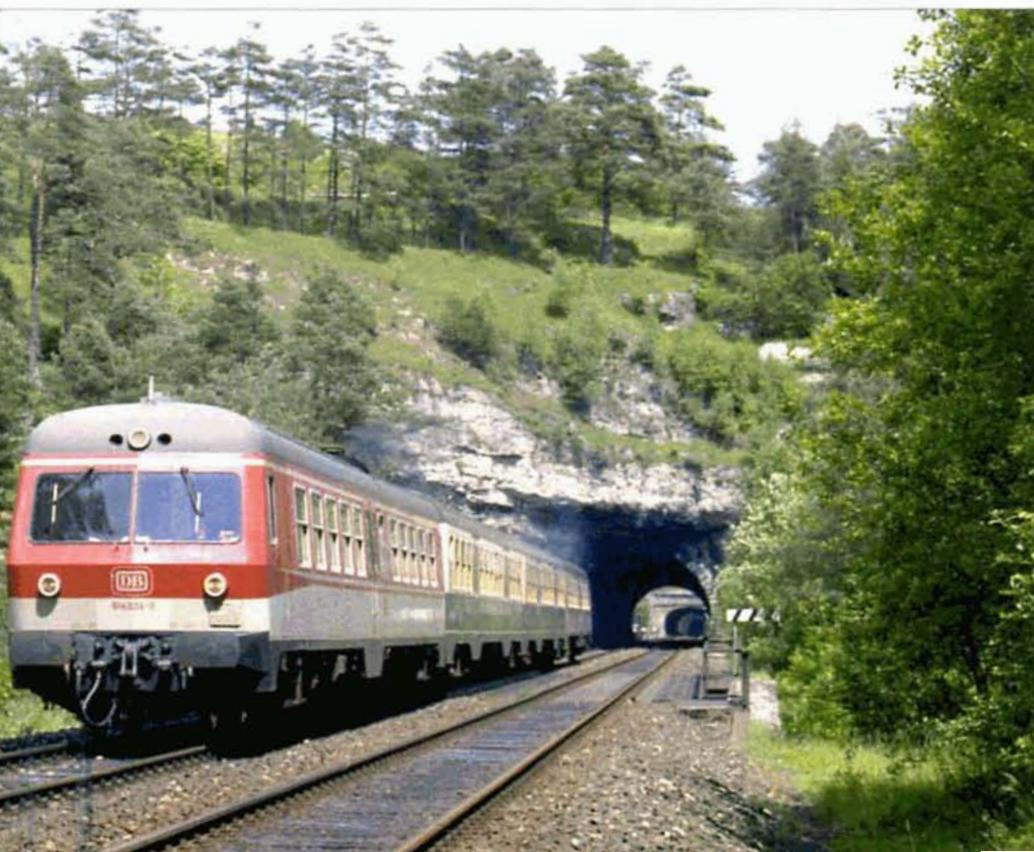
Equipés de moteurs MAN D3650HM12U de 370 kW et d'une transmission hydraulique, les 614 pouvaient circuler à 140 km/h. Vingt-six autorails ont par la suite été remotorisés avec des moteurs Cummins de 448 kW.
