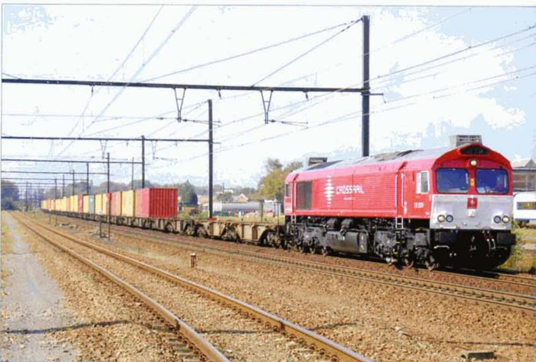
**PHOTO 106-34** ↑ La DE6311 "Hana" photographiée le 15 septembre 2011 au même endroit à Hasselt, à proximité de l'atelier de traction qui se trouve à droite. Cette Class 66 a été mise en service le 30 août chez Crossrail. On remarquera le caisson de l'airco placé sur la toiture au-dessus du poste de conduite. Tim VAN ROOY.
