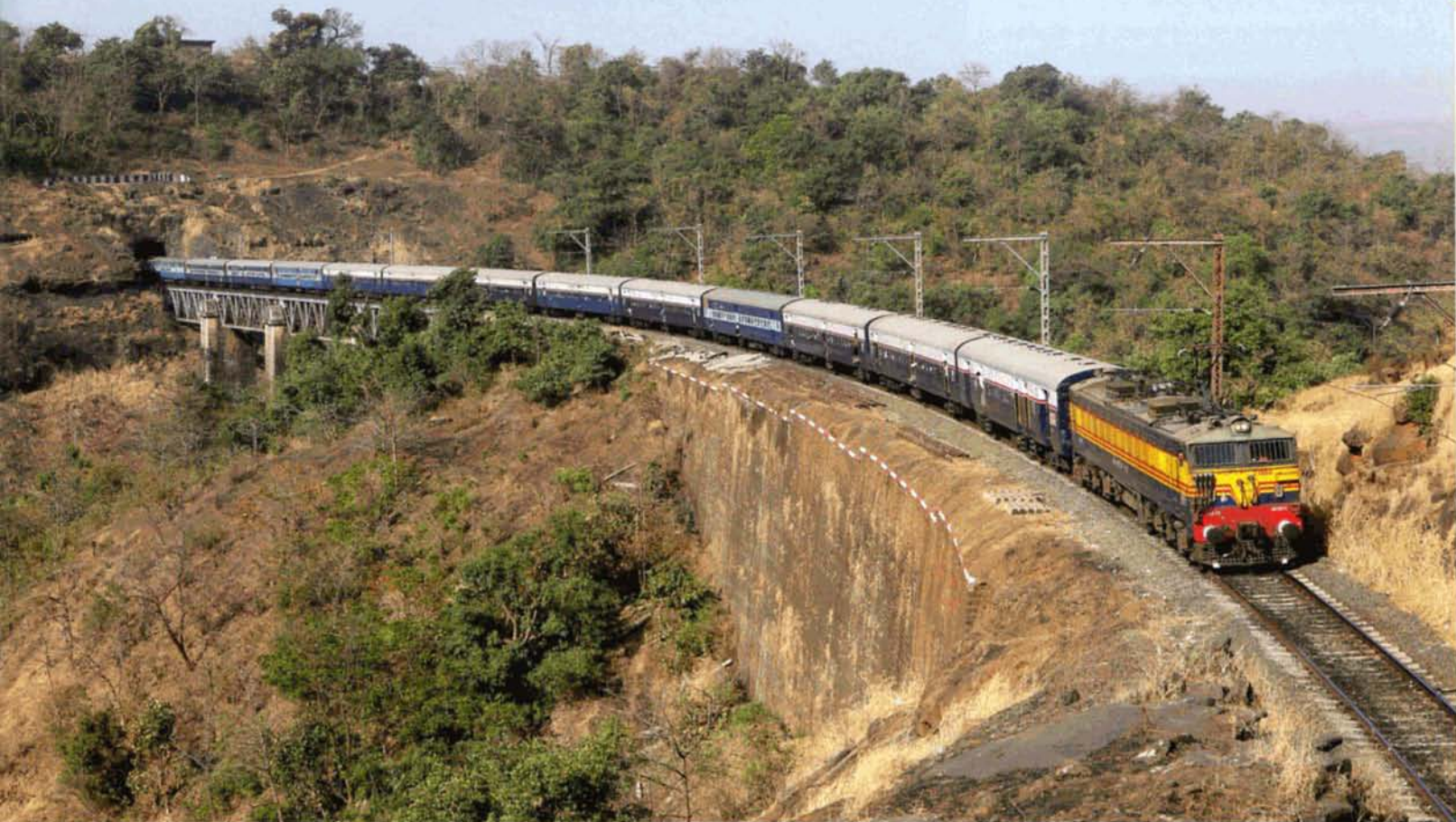
PHOTO 110-98 Un train de voyageurs franchit le viaduc de Bhima I et se dirige vers Igatpuri. En tête, la WCAG1-21980. Les WCAG1 ont été construites en 1999 et 2000 en 12 exemplaires par Bharat Heavy Electricals Ltd (BHEL) et sont équipées de convertisseurs statiques pour l'alimentation des auxiliaires fournis par les ACEC. Elles peuvent circuler à 100 km/h et disposent d'une puissance de 2154 kW sous 3 kV et 3470 kW sous 25 kV. Philippe DE GIETER, 22 février 2012.
