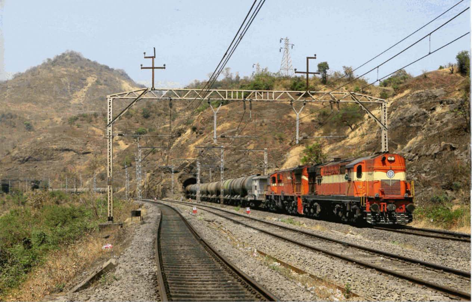
PHOTO 110-102 Une rame de pétrole monte péniblement Monkey Hill. Les deux locomotives Diesel, les WDG3A-14715 + 13583 (2250 kW, 123 t, 100 km/h), nous offrent un spectacle sonore inoubliable. Trois locomotives électriques non visibles poussent le train. Philippe DE GIETER, 26 février 2012.
