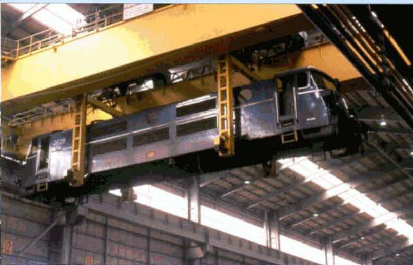
PHOTO 110-04 ↑ - PHOTO 110-05 ↗ La 2629 subit sa première révision générale à l'Atelier Central de Salzannes du 31 mars au 9 juillet 1980. A cette occasion, elle reçut la nouvelle décoration bleue avec "bavette jaune". A gauche, le 9 avril 1980, la caisse est transférée vers une autre voie à l'aide du portique géant de levage. A droite, le 5 juillet 1980, la révision de la machine est pratiquement achevée; elle sortira après les derniers réglages. Photos Julien CASIER, collection PFT.
