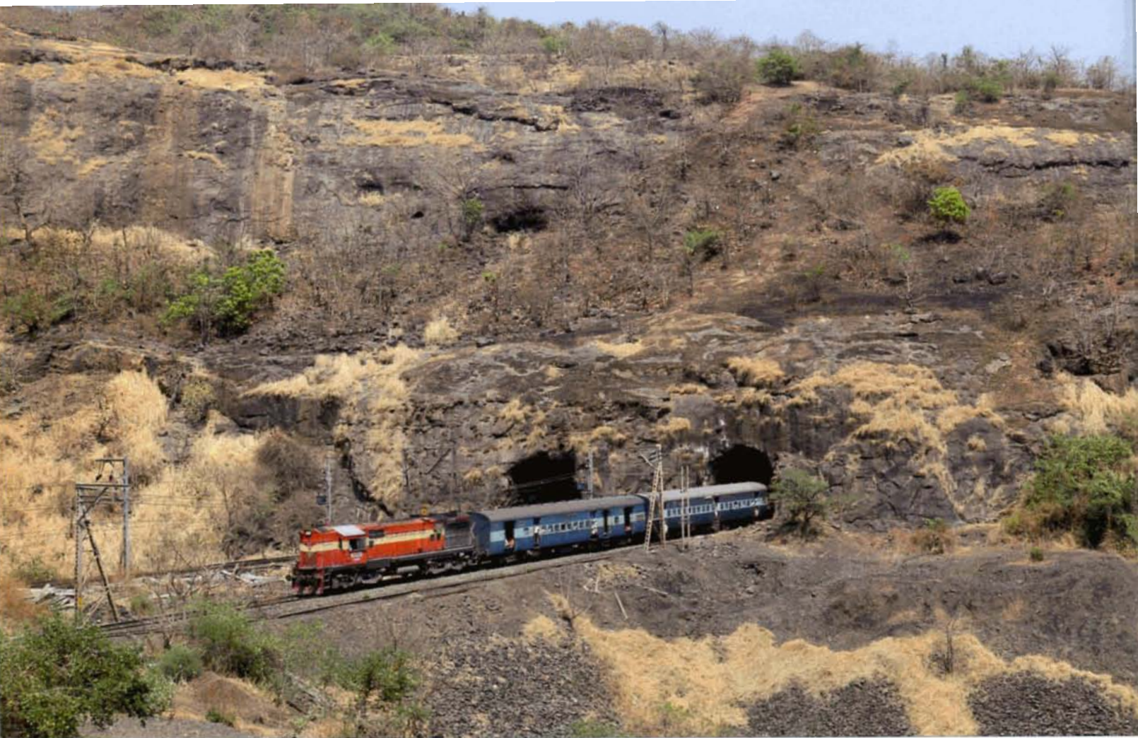
PHOTO 110-104 Un train de voyageurs remorqué par la WDM3A-16333R (Co'Co', 2527 kW, 112,8 t, 120 km/h) descend Monkey Hill. La troisième voie se trouve à droite de la photo (visible sur la photo de droite page suivante). Jambrung, 27 février 2012. Jean-Luc VANDERHAEGEN.
