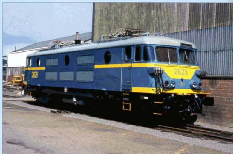
PHOTO 110-04 ↑ - PHOTO 110-05 ↗ La 2629 subit sa première révision générale à l'Atelier Central de Salzannes du 31 mars au 9 juillet 1980. A cette occasion, elle reçut la nouvelle décoration bleue avec "bavette jaune". A gauche, le 9 avril 1980, la caisse est transférée vers une autre voie à l'aide du portique géant de levage. A droite, le 5 juillet 1980, la révision de la machine est pratiquement achevée; elle sortira après les derniers réglages. Photos Julien CASIER, collection PFT.
