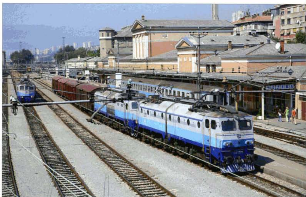
Le 4 septembre 2005, deux trains de marchandises remorqués par des 1061 attendent le départ en gare de Rijeka. A l'avant-plan, la 1061.105 (ex. JZ 362 105, constructeur Ansaldo 804/1968) avec cabines de conduite modernisées. Cette machine a été vendue au Ferrovia Nord Milano (E660.003) où elle n'a jamais été utilisée. Thierry COCHIN .
