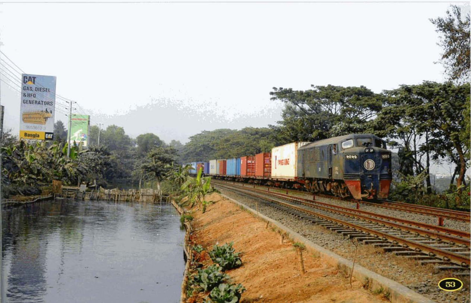
↑ PHOTO 115-85 - ↓ PHOTO 115-86 Entre 1953 et 1956, General Motors a livré une série de 39 locomotives du type GM B12 à voie métrique. Numérotées 2001 à 2039, elles constituent les plus vieilles machines du réseau. Seules quelques exemplaires circulent encore. Le 13 janvier 2013, la 2021 (ci-dessus) qui a perdu une partie de son carénage à l'avant du bogie, et la 2023 (ci-dessous) remorquent des trains de conteneurs, photographiés le long des étangs d'élevage de poissons-chats. Yves STEENEBRUGGEN.
