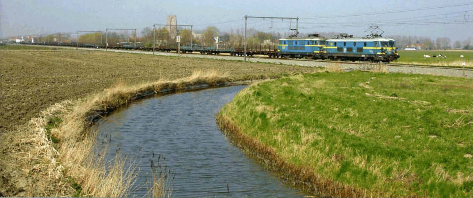
PHOTO 115-59 ↑ Les 23 circulaient souvent un unité multiple avec les locomotives de la série 26. Le 2 avril 2009, un train de conteneurs vides vient de quitter Zeebrugge avec les 2367 et 2618 en tête. Serge MARTIN.
