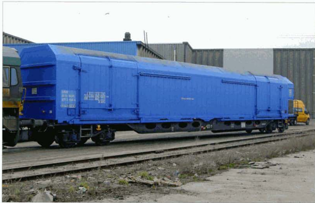
↑ Un des 12 wagons frigorifiques pris en location par Railtraxx (n° NEV 37 80 D-BUVL 877 3 826-6). Ces véhicules sont équipés d'un groupe électrogène (visible à l'extrémité droite du wagon) fournissant l'énergie pour le fonctionnement des frigos. Antwerpen, quai 216, 10 avril 2013. Luk GIBENS.
