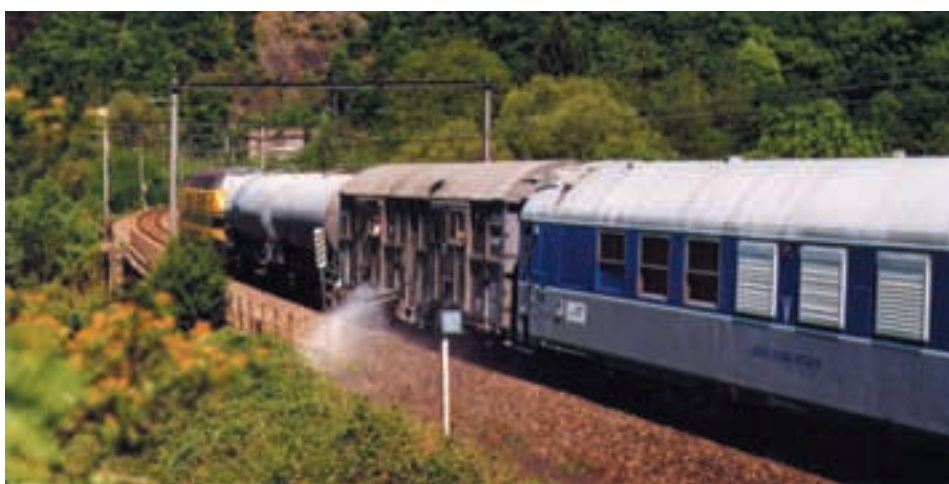
Le train de désherbage pulvérise 3.000 km de lignes 2 fois par an.
