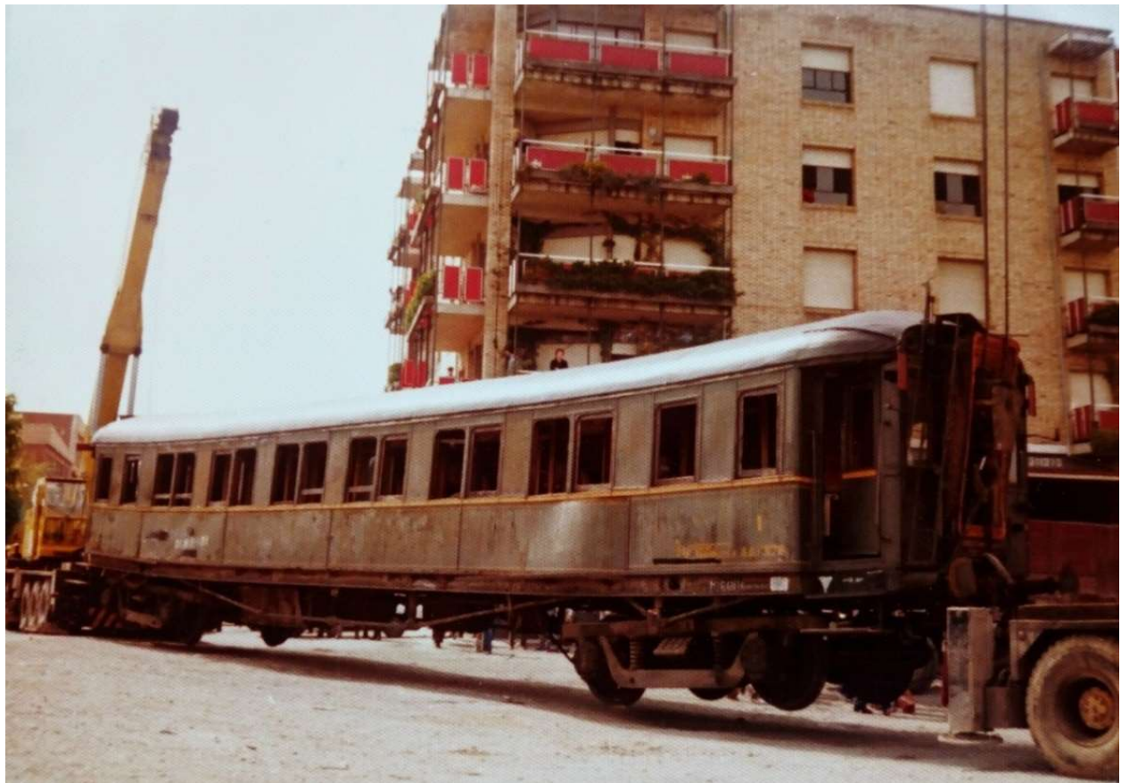
Operaciones de traslado desde las vías por las calles de Miranda de Ebro hasta su pedestal. Obsérvese que hubo que cortar las dos vías generales durante el tiempo en el que estuvieron trabajando varias grúas. Fotos Alfonso López Zaragoza.
