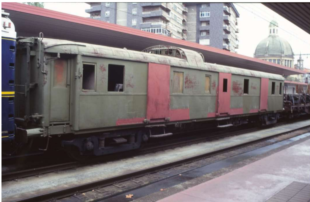
Foto detalle del furgón WL-1276 en proceso de saneamiento, con pintura de imprimación y antioxidante en puertas correderas. Estación de Irún 1 de noviembre de 1996. Foto cortesía Koldo.
