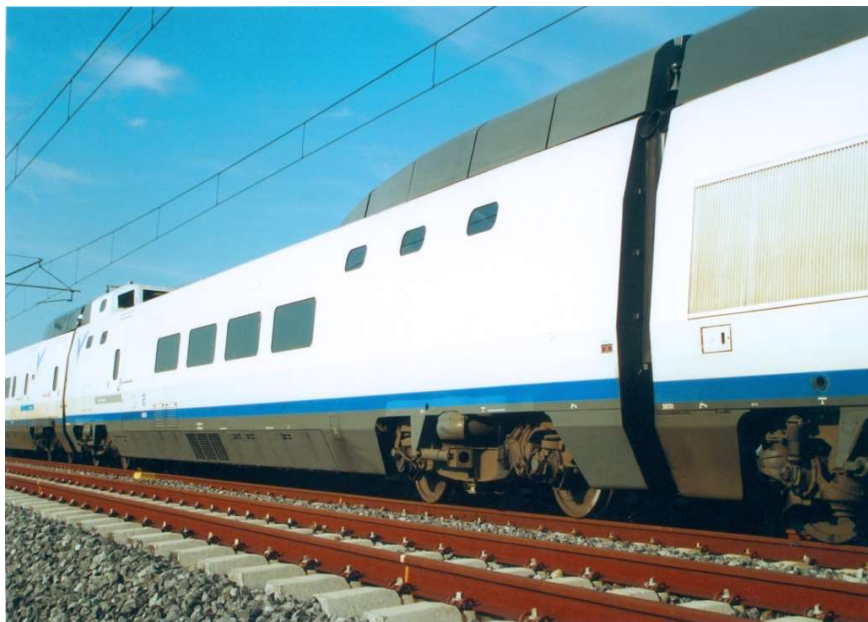
Coche de Control agregado a una rama de la serie 100 de RENFE-AVE. Pruebas a 300km/h. Foto Chema Martínez.
