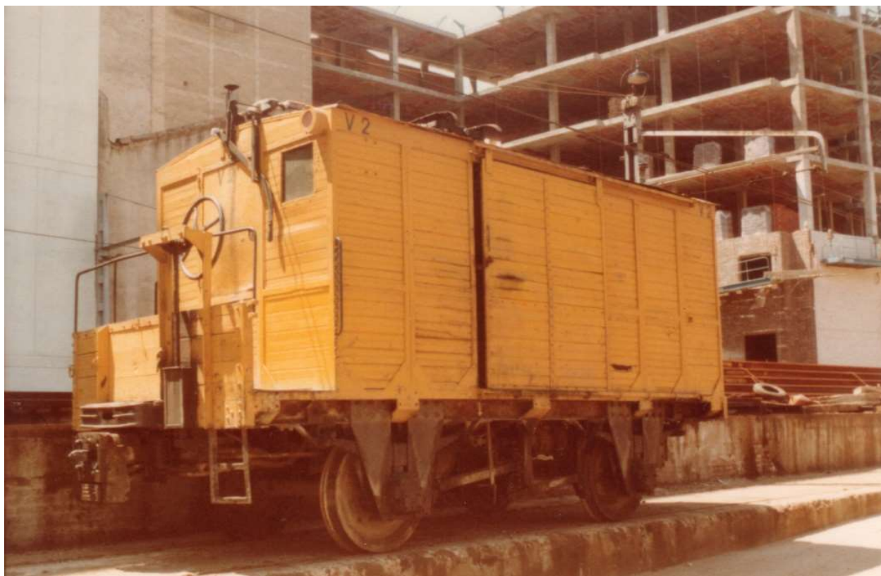
Vagón cerrado de madera V2, destinado a Servicios Auxiliares. Obsérvese que disponía de pértiga para grupo electrógeno – soldadura eléctrica. Año 1978. Instalaciones del depósito I de Cuatro Caminos. Actualmente desguazado.
