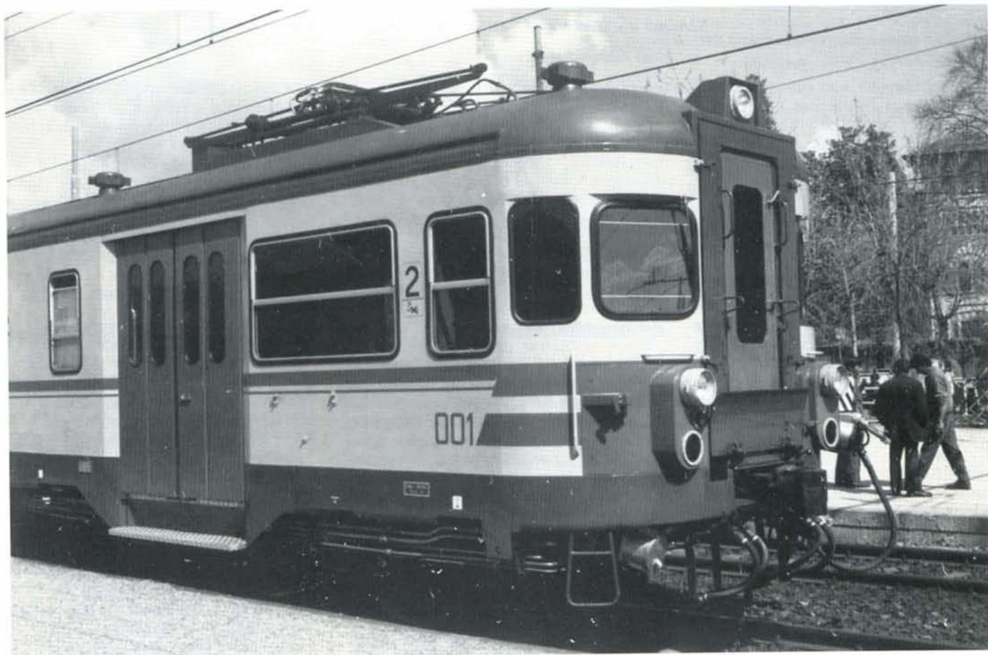
**PHOTO THEME 9** Une vue en gros plan de la partie avant : on remarquera les nouvelles fenêtres remplaçant le pare-brise arrondi d'origine et les nouveaux phares.
