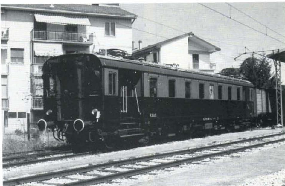
**PHOTO 18-28** L'automotrice historique E 623.100 remise dans la livrée brun clair et brun foncé photographiée au dépôt de Pesciola le 6 avril 1994. Cette automotrice a été rachetée en 1990 aux FS. Elle fut construite en 1932 par Breda et la Compagnia Generale di Eletticità de Milano. A l'origine, elle fonctionnait sous une tension continue de 650 V captée par troisième rail (numéro d'origine : FS E 100). En 1951 elle fut modifiée pour circuler sous le 3.000 V=.
