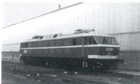
*La 2010 est sortie de réparation le 9 mars dernier. Il s'agit d'un remarquable travail de reconstruction, la caisse (et l'équipement correspondant) côté cabine 1 ayant été détruite sur environ un tiers de sa longueur. On remarquera la dimension plus grande des chiffres. AC-Salzinnes, 9 mars 1994. Photo : Christian VANHECK*
