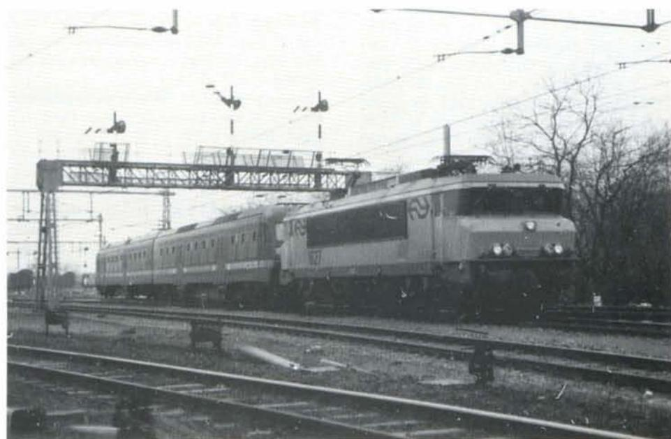
**PHOTO 18-16** Plus récemment, le 29 avril dernier, c'est la gare de Roosendaal qui a vu ses derniers signaux mécaniques remplacés par des cibles lumineuses. Disparaît ainsi du côté nord de la gare le célèbre portique qui supportait deux palettes, lesquelles autorisaient le départ des convois quittant la formation.
