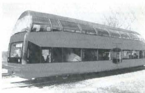
Le nouvel autorail léger à deux étages construit par Waggonbau Dessau. Ici, l'engin prototype duquel découle la série 670 de la DB.
