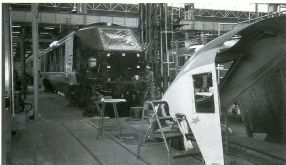
La motrice Eurostar 373.221 (SNCF) en réparation à l'Atelier Central de Mechelen, après sa collision avec un camion au passage à niveau de Ligne le 11 mars 1997 (voir EN LIGNES 30 page 25). Photo : Jan PEETERS.
