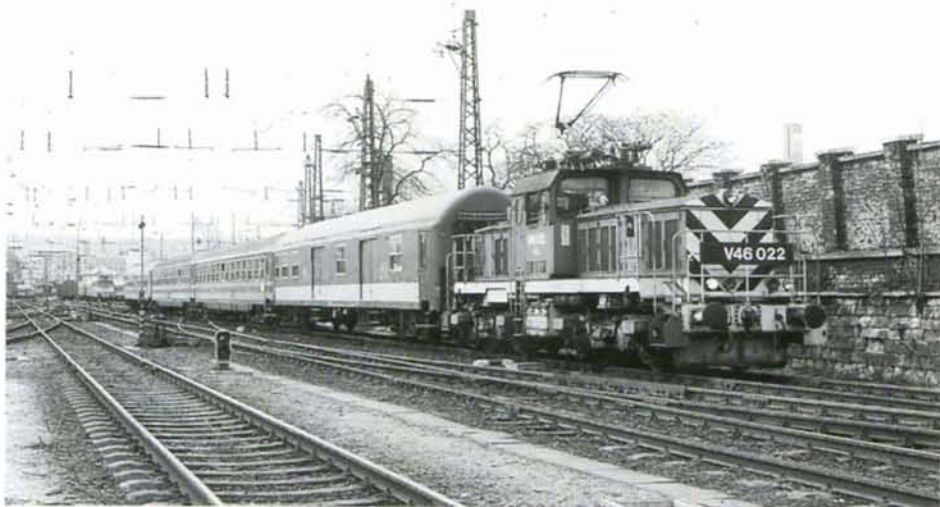
PHOTO 31-05 Les V46 sont utilisés pour les manoeuvres dans les principales gares électrifiées et pour des mouvements locaux de marchandises. La V46-022 manoeuvre une rame italienne à Budapest-Keleti le 12 avril 1997. Photo : Jean-Luc VANDERHAEGEN.
