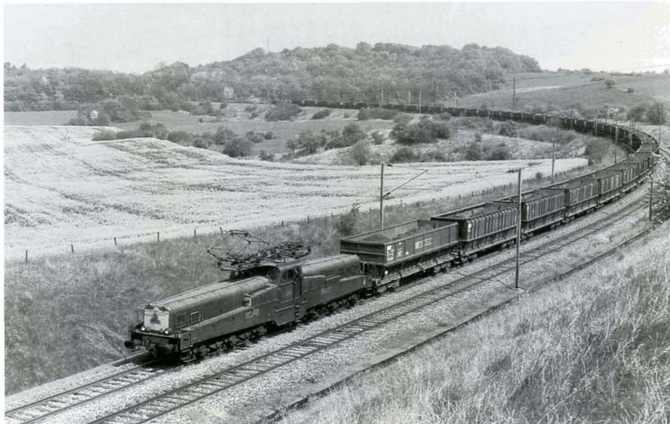
PHOTO 31-07 Un train de minerais se dirige vers Audun-le-Roman. La CC 14.123 assure la pousse de la lourde rame. Au fond de l'image, on distingue la CC 14.100 assurant la traction en tête du convoi. Sancy, 24 avril 1992. Photo : Jean-Luc VANDERHAEGEN.
