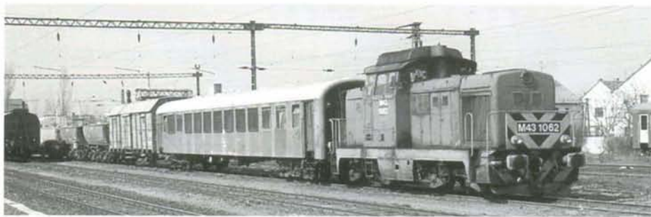
PHOTO 31-25 Les M43 et M47 d'origine roumaine sont apparues à partir de 1974; elles sont visibles sur l'entièreté du réseau et affectées à toutes les tâches. La M43.1062 en tête d'un train de désherbage à Kecskemet, 11 avril 1997. Photo : J-L VANDERHAEGEN.
