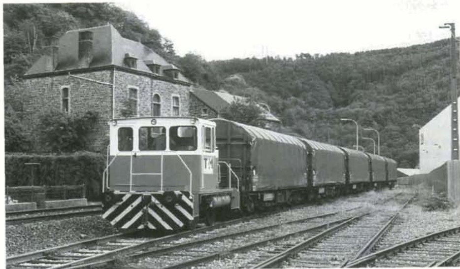
Le nouveau locotracteur Cockerill acquis d'occasion par TDM manoeuvre une rame de 5 wagons dans le faisceau de l'usine. Il s'agit d'une machine (Cockerill 4205/1967) appartenant à CMI qui se trouvait auparavant en location chez Glaverbel à Moustier-sur-Sambre. Ces wagons transitent par le tunnel sous la Manche. Photo : P. STERCK.
