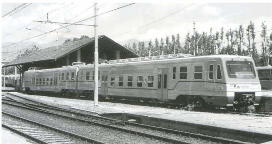
PHOTO 31-02 Les nouvelles automotrices du SATTI ont été mises en service dans le courant du mois de juillet. Au nombre de 7, ces très belles rames sont pourvues d'un compartiment central avec plancher surbaissé. La ETR Y0530 M1-007 + M2-007 est photographiée le 20 juin 97 au dépôt de Cirié, peu après sa réception. A. DEFECHEREUX.
