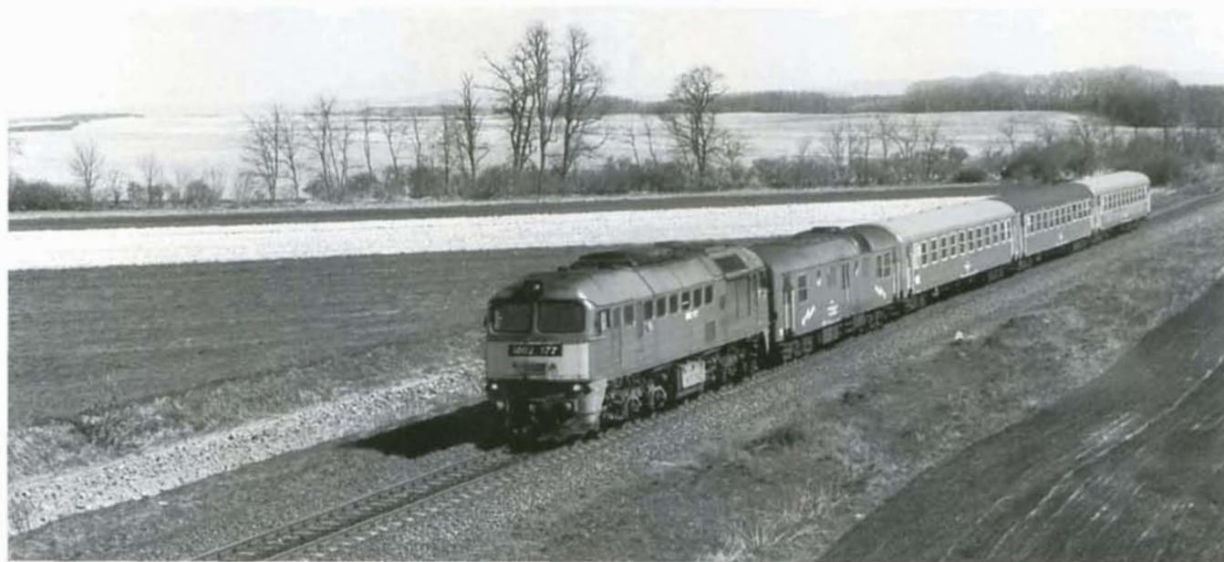
**PHOTO 32-32** *Le train 8542 Balatonszentyörgy-Nagykanyzsa, remorqué par la M62.177. Derrière la locomotive se trouve un fourgon générateur assurant le chauffage électrique de la rame. Zalakomar, 8 avril 1997. Photo : Philippe DE GIETER.*
