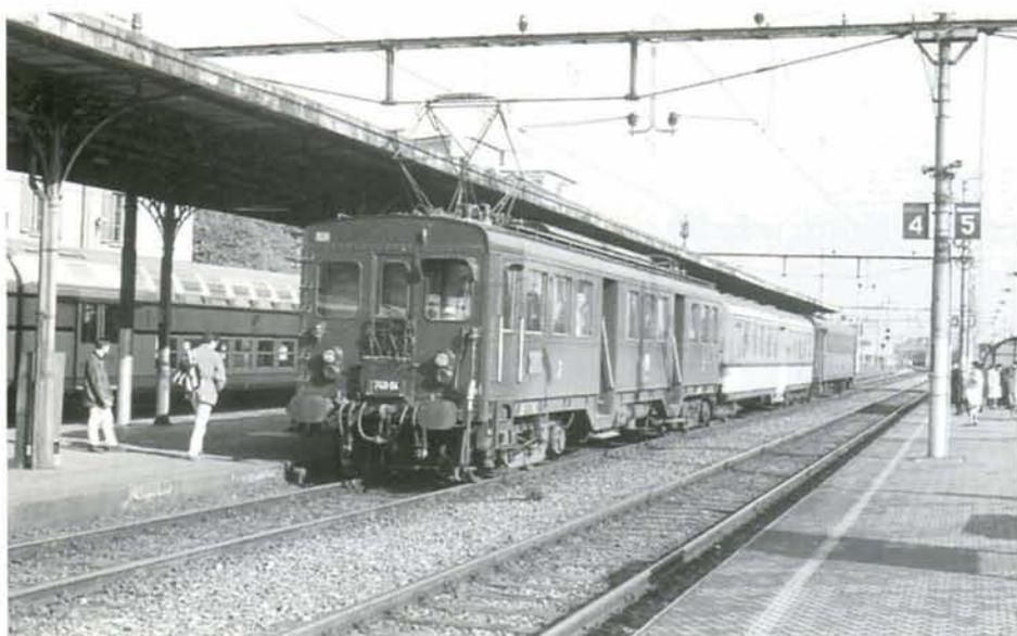
**PHOTO 32-07** La E 610-02, une des quatre BoBo livrées en 1949 par Breda et CGE, manoeuvre une voiture M3 à l'atelier de Milano Novate Milanese le 12 mars 1996. Cette machine est repeinte dans la nouvelle décoration vert-blanc. J-L VANDERHAEGEN.
