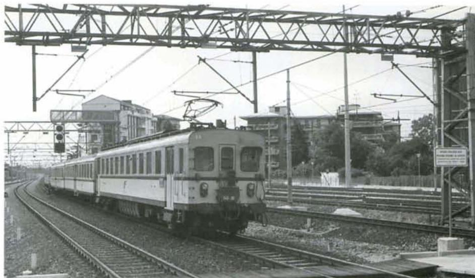
**PHOTO 32-03** Le 25 juillet 1993, l'automotrice 740-20 (constructeurs : Breda et CGE à Milano, 1957) quitte la gare de Milano-Novate Milanese. Il s'agit d'une automotrice de seconde génération, reconnaissable par son châssis droit et ses portes situées aux extrémités. La rame est composée de deux voitures suisses et d'une voiture-pilote, le tout en livrée orange et blanche. Photo : Jean-Luc VANDERHAEGEN.
