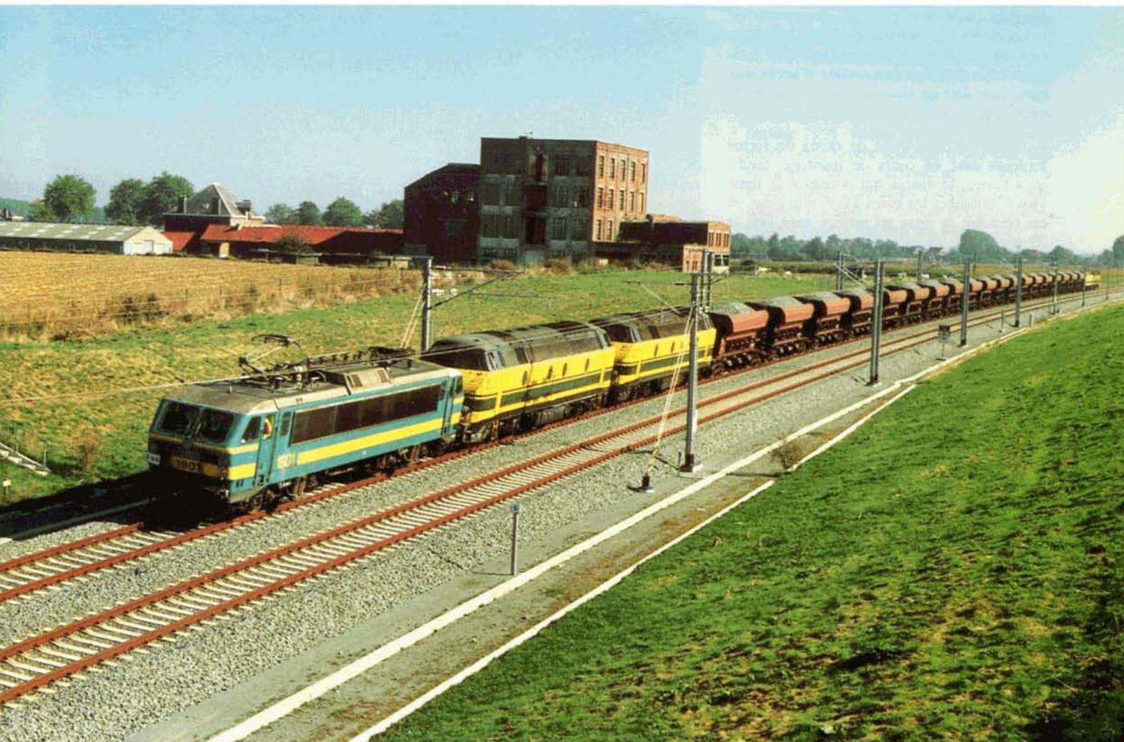
**PHOTO 32-66** Le 26 septembre, la 1901 assure un essai de traction dans le but de vérifier l'alimentation fournie par la sous-station de Chièvres. Le train, était composé de la 1901, de deux 55, d'une rame chargée de ballast, et de deux 59 en queue. Le convoi passe à Hoves. Dia : Christian DOSOGNE.
