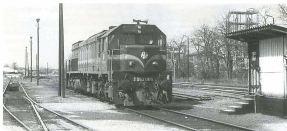
**PHOTO 32-38** Lors de l'éclatement de la Yougoslavie, les 14 Co'Co' du type 663 des JZ sont passées aux HZ où elles prirent les numéros 2.063.001 à 014. Construites en 1972 par GM aux USA, elles sont, avec leur moteur Diesel GM 16 cylindres de 2426 kW, les plus puissantes du réseau. La 2.063.006 repeinte dans la superbe livrée croate bleu avec bandes argentées, est garée à Cakovec. Photo : Yves STEENEBRUGGEN.
