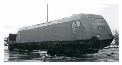
PHOTO 34-18 Les caisses des nouvelles locomotives de la série 101 de la DB sont assemblées par la firme polonaise PAFAWAG. Elles sont ensuite transférées par... camions vers l'usine ADtranz de Kassel en Allemagne où la locomotive recevra tout son équipement. Une future 101 posée sur une remorque routière, photographiée sur un parking d'autoroute près de Dresden, le 8 décembre 1997. Photo : A. DEFECHEREUX.
