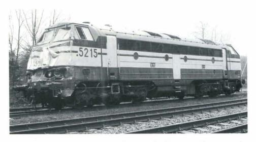
PHOTO 34-29 Les dégâts à la 5215 sont beaucoup plus limités. La cabine sera remplacée par celle provenant de la 5217. Gedinne, 14 mars 1998. Photo : K. AVONDS.
