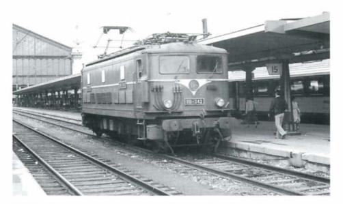
PHOTO 34-05 La BB 342 assure un service de manoeuvres à Paris-Austerlitz, le 14 juillet 1979. Cette machine de la seconde série fut mise en service à Saint-Pierre-des-Corps le 14 avril 1947. Elle fut versée à la manoeuvre le 20 février 1984 au dépôt de Limoges. Sa carrière s'acheva à Vénissieux le 3 avril 1989. Jean-Luc VANDERHAEGEN.
