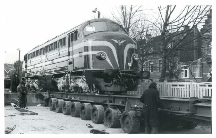
PHOTO BD-026 Les quatre documents qui suivent illustrent le transport de la 204.004, le 3 mars 1958. En gare de Jette, la machine est tirée à l'aide d'un treuil sur la remorque routière allemande à 32 roues. Photo : Bruno DEDONCKER, collection PFT ©.
