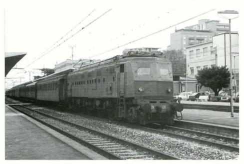
PHOTO 34-10 La E 428.126 (Breda, 1939) faisant partie de la seconde tranche (E428.123 à 203), en tête d'un train local en provenance de Bologna. On remarquera la composition hétéroclite de la rame. Parma, 25 mai 1985. Photo : J-L VANDERHAEGEN.
