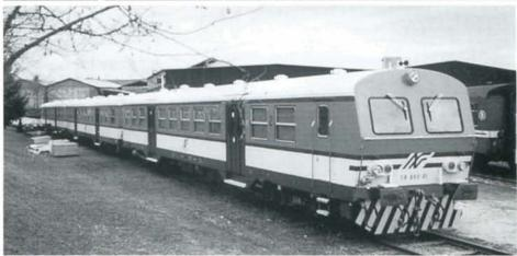
La voiture EB 880-01 du Ferrovie Nord Milano (FNM), ex. M2 SNCB, transformée avec une cabine de conduite. Cette transformation a été réalisée sur base des plans SNCB des M2 BDx électriques. Pour rappel, le FNM avait racheté en 1997 un lot de 24 voitures M2 (voir EL 32 p. 4 à 11). Atelier de Metalmeccanica Milanesio, 8-12-97. M. CERUTTI.
