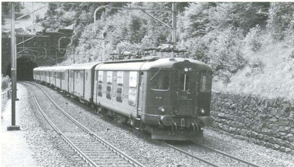
**PHOTO 35-04** Le 21 juillet 1981, un train local remorqué par la Re 4/4 I 10008 descend la rampe sud du St.Gothard en direction de Ertsfeld. Il s'agit d'une locomotive de la première série reconnaissable par la présence d'une porte d'intercirculation.
