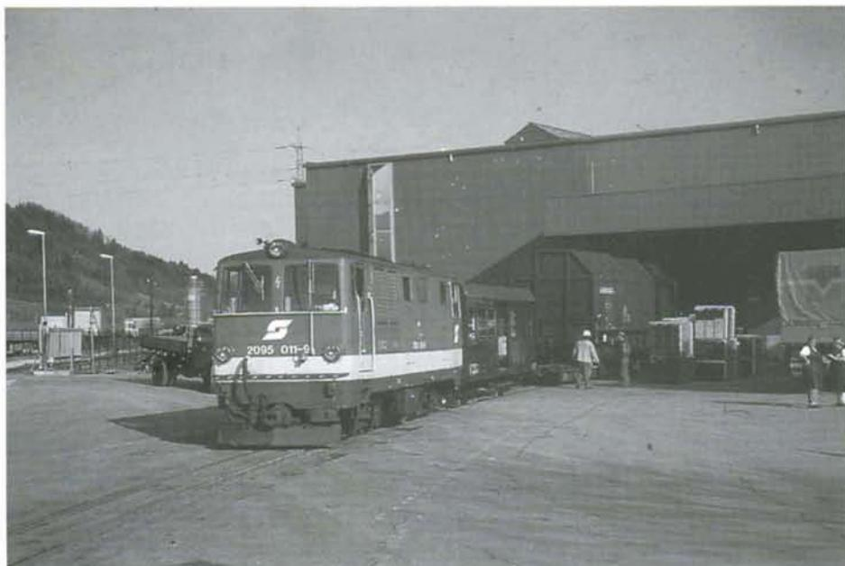
*Le 3 avril 1998, la 2095.011 (SGP 18155/1962) dessert pour la dernière fois le raccordement de la firme Welser à Gresten. Les 15 locomotives de ce type furent construites de 1958 à 1962. Ces B'B' à transmission hydraulique, d'une masse de 30 t, disposent d'une puissance de 440 kW. Photo : Wim DERIDDER.*
