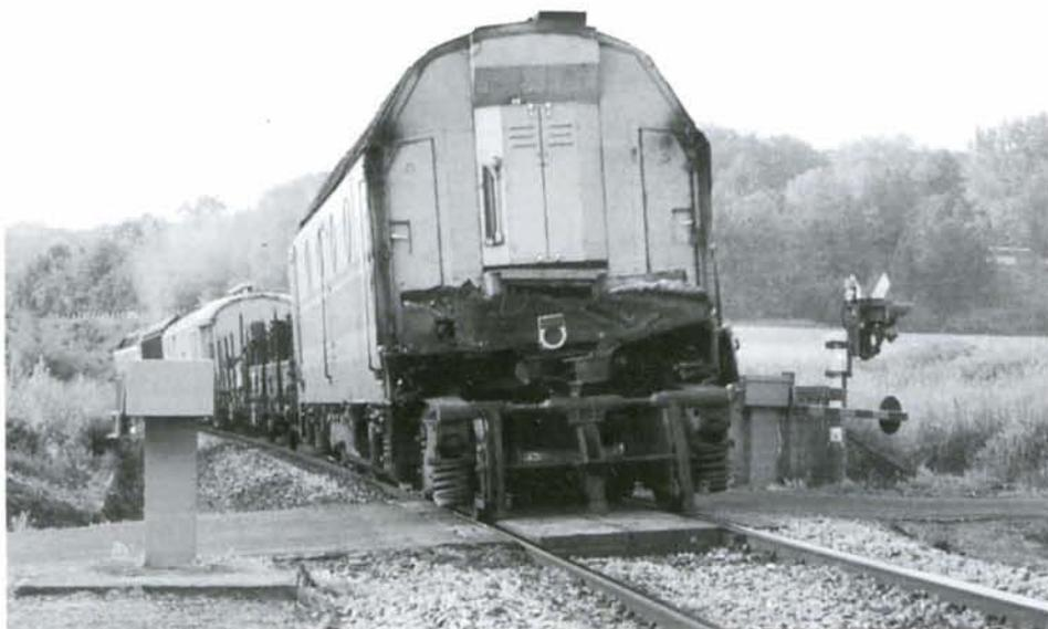
*Le rapatriement vers l'atelier de Merelbeke de la 6206 accidentée à Renaix (voir EL 34), s'est déroulé le 20 mai dernier. Pour permettre ce transfert, la cabine de conduite démolie a dû être entièrement démontée! Photo : Philippe NOTTE.*
