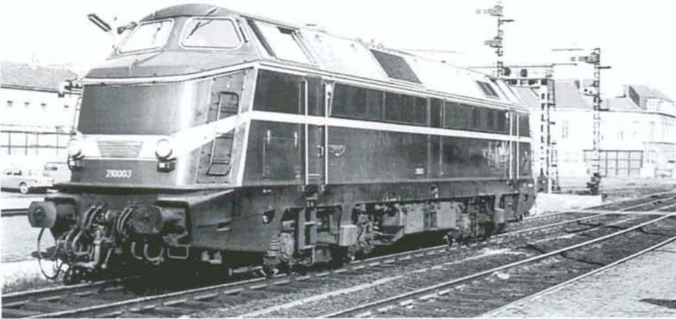
Deux vues anciennes pour illustrer notre unique acquisition en 1995 : la locomotive Diesel 6003 (ex. 210.003). Les six prototypes numérotés 201.001 à 210.006, futurs 6001 à 6006, furent construits en 1960 par Cockerill. Par rapport aux 210 de série, elles avaient la particularité d'avoir une caisse semblable aux types 200 (future série 51), mais raccourcie. Ci-contre en 1962 à Kortrijk.
