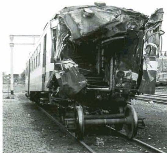
**PHOTO 36-14** ☞ et **PHOTO 36-15** ☜ *Même s'ils sont impressionnants, les dégâts subis par la 929 sont relativement faibles. On remarquera que la structure de la caisse et du châssis n'a pas bougé; seul le carénage de la cabine a été détruit. Par contre, il n'en va pas de même de la voiture M2 49226 très gravement endommagée.* Photos : Kristof AVONDS et Jean-Luc VANDERHAEGEN.
