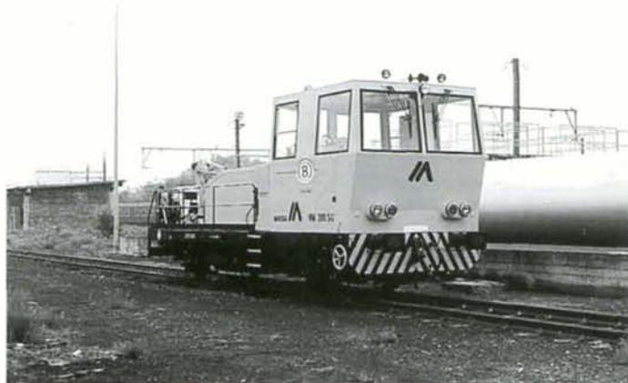
↑PHOTO 36-43 et PHOTO 36-44 ↗ La nouvelle draine Matisa spécialement équipée pour procéder au remplissage des graisseurs mécaniques de rails. Ronet, 2 août 1998. Les participants à notre grand voyage sur la Vennbahn, le 8 août dernier, ont pu observer ce véhicule garé à Trois-Ponts. Photos : Jean-Luc VANDERHAEGEN.
