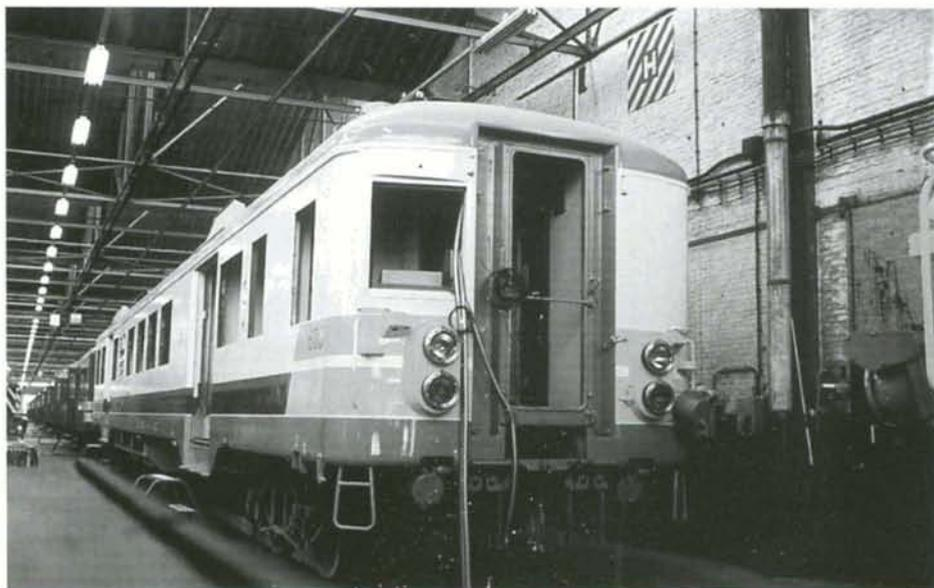
**PHOTO 36-13** La modernisation de l'automotrice 606 à l'Atelier Central de Mechelen, en août 1998. On remarquera la suppression de la fenêtre du compartiment haute tension (à droite). Photo : Alain DEFECHEREUX.
