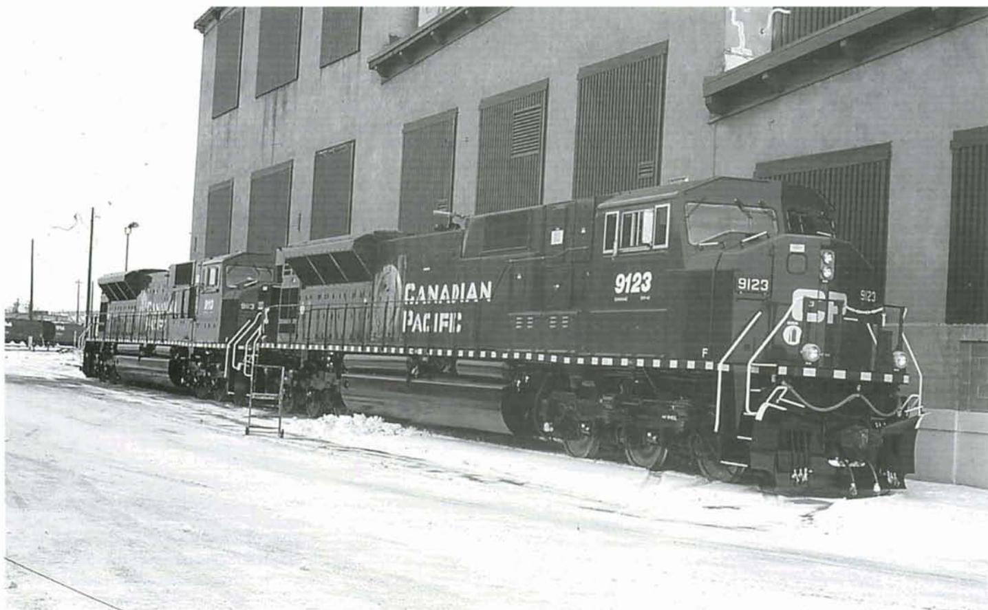
*Aux ateliers Odgen Shops à Calgary, les SD90MAC 9123 et 9113 des CP en phase de test avant leur livraison, le 5 janvier 1999. Ces monstres sont capables de remorquer des charges de 11400 tonnes à 65 km/h en simple traction! Leur coût de construction n'atteint même pas la moitié de celui d'une locomotive de la série 13 de la SNCB... Photo : Christian SCHMITZ.*
