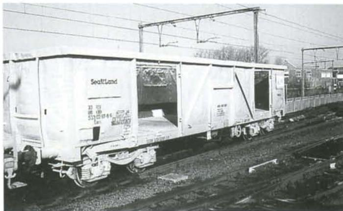
Une nouvelle série de wagons tombereaux à bogies du type Eaos est en cours de transformation pour le transport de conteneurs par la firme Inter Ferry Boats. Le travail est réalisé par l'Atelier Central de Gentbrugge. Le 6 février 1999, l'Eaos 33 88 5330 2879 est manoeuvré à Gentbrugge. Photo : Roger CRİKELAIRE.
