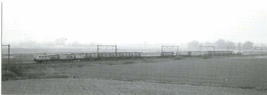
**PHOTO 38-30** Toutes les 6 semaines, un train de mesures de la SNCF parcourt la LGV 1 jusqu'à Lembeek afin de vérifier le bon état de la voie. La rame, encadrée par les BB 622399 (BB 22399) et BB 622379 (BB 22379), est composée d'une voiture-salon et des voitures de mesures Hélène et Mauzin. Bifurcation de Beauregard à Silly, 10 février 1999.
