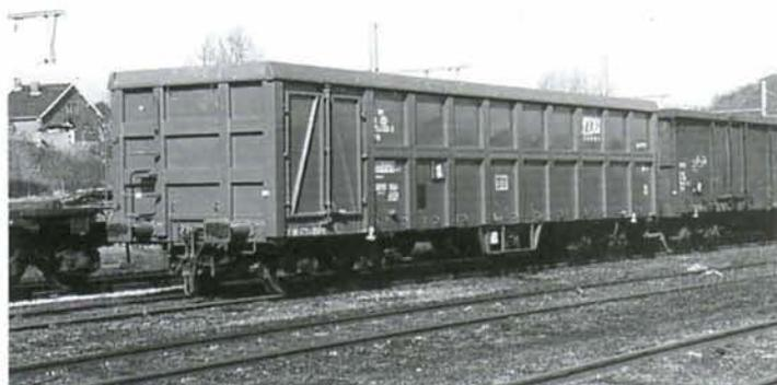
**PHOTO 38-18** Comme annoncé dans notre précédent numéro, la SNCB transforme pour le transport de ferraille une série de 130 wagons tombereaux du type Eaos. Ces véhicules, désignés Fas type 1415G5, sont dotés d'une nouvelle caisse plus résistante et leur plancher en bois est remplacé par un plancher métallique. Le Fas 31 88 6734 0008 à Châtelet, le 11-03-1999. J. DELFORGE.
