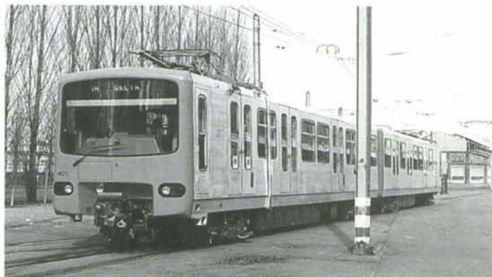
*La rame double n° 401-402 du métro bruxellois photographiée sur les voies d'essai de l'usine de Brugge. Etant donné que ces voies ne sont pas pourvues d'un 3ème rail, les deux voitures ont été provisoirement munies d'un pantographe. Photo : Marc GRIETEN.*
