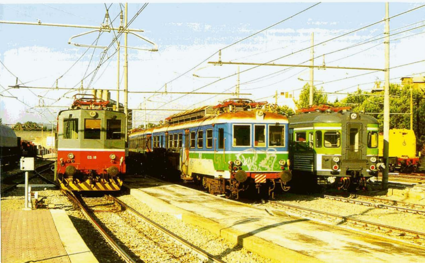
PHOTO 40-34 En gare de Pesciolo, le centre névralgique du LFI, l'automotrice ALe 056.149 stationne auprès de l'EBiz n°9 (TIBB, Reggiane 1954; 500 kW; v. max. : 70 km/h; masse totale : 44,4 t; 76 places assises) et du fourgon moteur EDz 18 (constructeur : TIBB, FERVET et le LFI en 1949; v. max. : 90 km/h; masse totale : 44 t; puissance : 500 kW). Photo : Kristof AVONDS.
