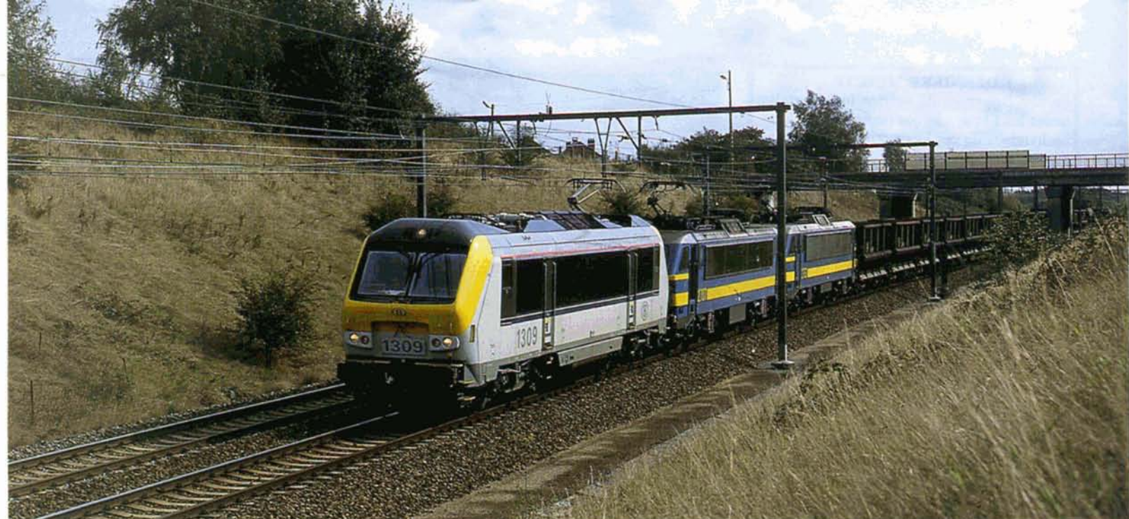
Le 25 septembre 1999, la 1309 fut testée en tête d'une lourde rame de minerai entre Monceau et Haine-St.Pierre, dont le début de la ligne comporte une longue section en très forte rampe. La 1309 était secondée par les 2707 et 2753. Photo : Wim WINDEY.
