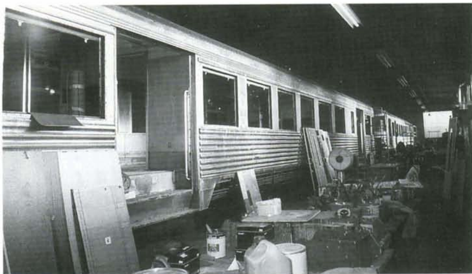
En février 1999, travaux à la carrosserie (remplacement des fenêtres) et à l'aménagement intérieur. Photo : Metalmeccanica Milaneseio.
