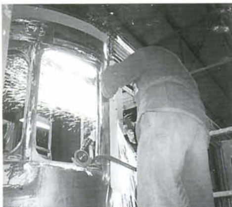
La suppression des pare-brise arrondis a nécessité de gros travaux de carrosserie.
