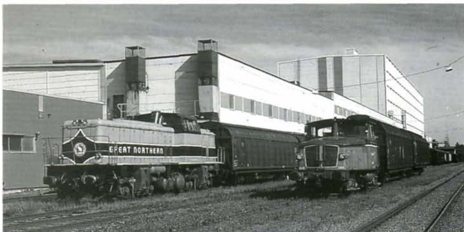
La T43.253 du TAGAB (ex. T43.253 SJ, NoHAB 2540/1963, moteur Diesel GM 12-567DA de 1445 ch), à Filipstad, le 28 juillet 1999. A droite, la Z65.203. Photo : Wim WINDEY.
