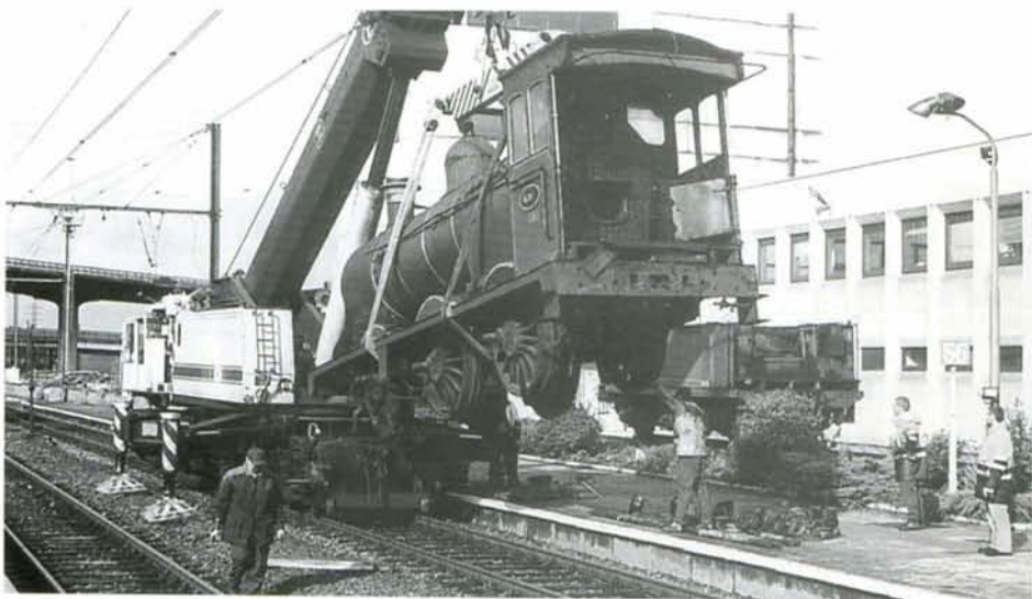
PHOTO 40-51 La 41.195 dans les airs, lors du retrait de son piédestal. Cette opération a nécessité le déplacement de la caténaire. Charleroi-Sud, 2-10-1999. Marc GRIETEN.
