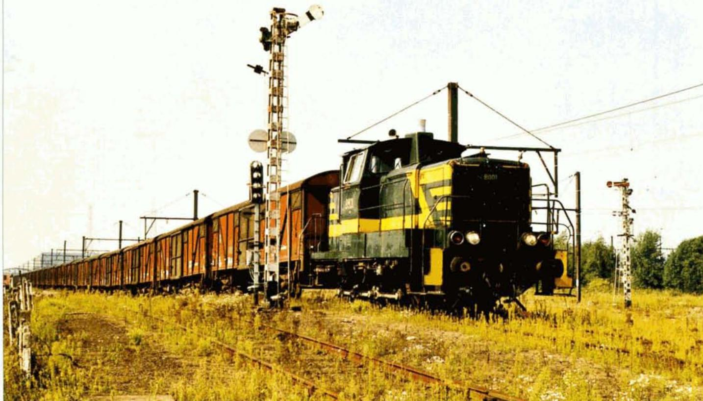
**PHOTO-THEME 40** Le groupe B était exclusivement commandé par des signaux mécaniques. Mis hors service en 1995, ces signaux étaient les tout derniers mécaniques de la région bruxelloise. Le 6 septembre 1989, la 8001 franchissait une des bosses en tête d'une rame de wagons Gbs, en direction du faisceau.
