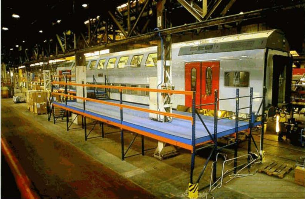
**PHOTO 47-32** La première voiture à deux niveaux du type M6 est enfin arrivée fin juin chez Bombardier à Brugge. Pour rappel, la SNCB a commandé 210 voitures M6. Les caisses et bogies sont construits en France, tandis que Bombardier à Brugge assure l'habillage intérieur et les finitions. Bombardier, Brugge, 17 août 2001. Christian DOSOGNE.
