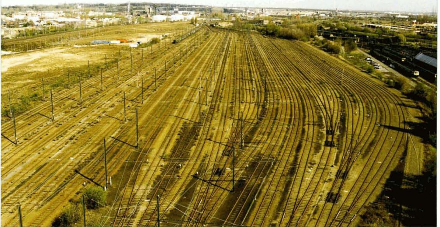
**PHOTO-THEME 40** Le groupe A comprenait 31 voies. Il servait principalement à la réception des trains devant se faire trier. A l'extrême droite, on voit l'atelier de traction électrique. La nouvelle ligne à grande vitesse 25/1 sera établie au milieu du groupe A. Alain DEFECHEREUX.
