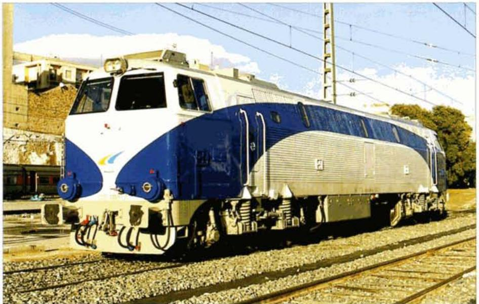
La 333.081-8 repeinte dans les couleurs d'ARCO (trains rapides de grand confort). Alicante, avril 2001. Cet engin fait partie d'une série de 93 locomotives pratiquement identiques aux MZ des Chemins de fer danois (voir EL 43 page 33), construites par Meinfesa de 1974 à 1976 et équipées d'un moteur Diesel GM 16-645 E 3 de 1875 kW. Felipe ARANDA.
