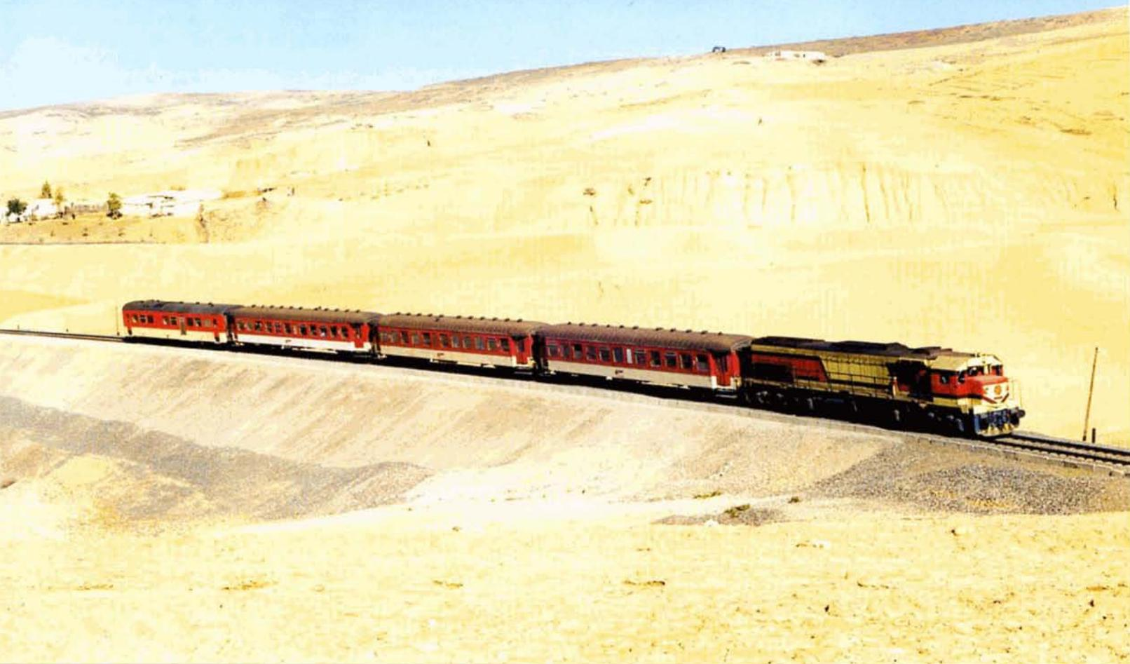
**PHOTO 47-75** C'est la DH 353 qui nous mène jusqu'à Taza. Cette imposante locomotive de 3000 CV fut construite par GM-EMD en 1973. Arrêt-photo au début de la grande courbe en forme de fer à cheval, qui permet de gravir le col de Touabaa. Le paysage n'est pas sans rapprochement avec des sites martiens photographiés par la sonde Mars Global Surveyor...
