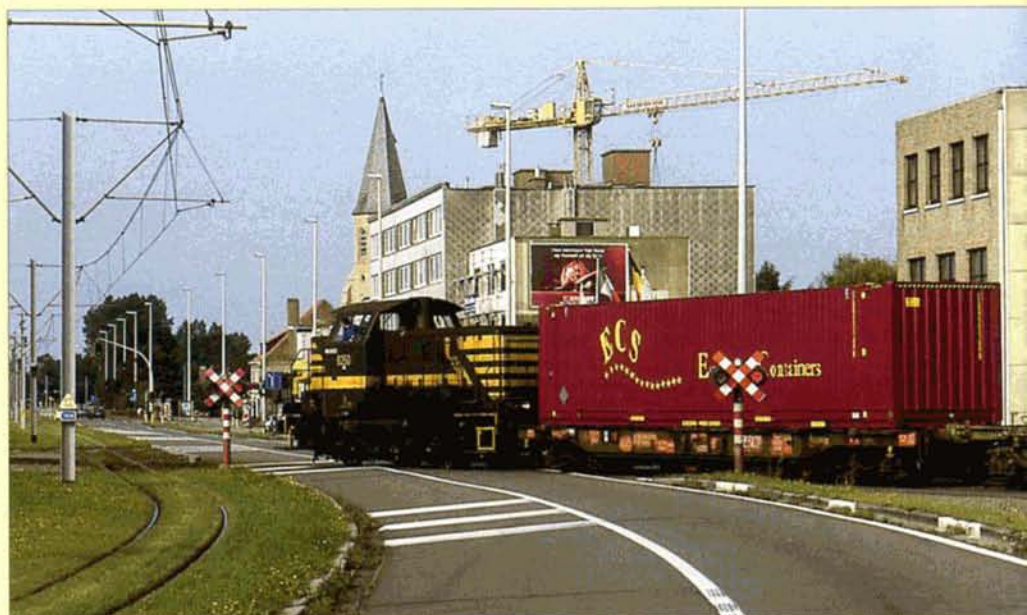
Un des 119 "wagons-kangourous" ou "wagons-poches" type Sdkmss de TRW traverse la Kustlaan à Zeebrugge en direction du Zweedse Kaai (ligne industrielle 202), le 22 juillet 2001.
