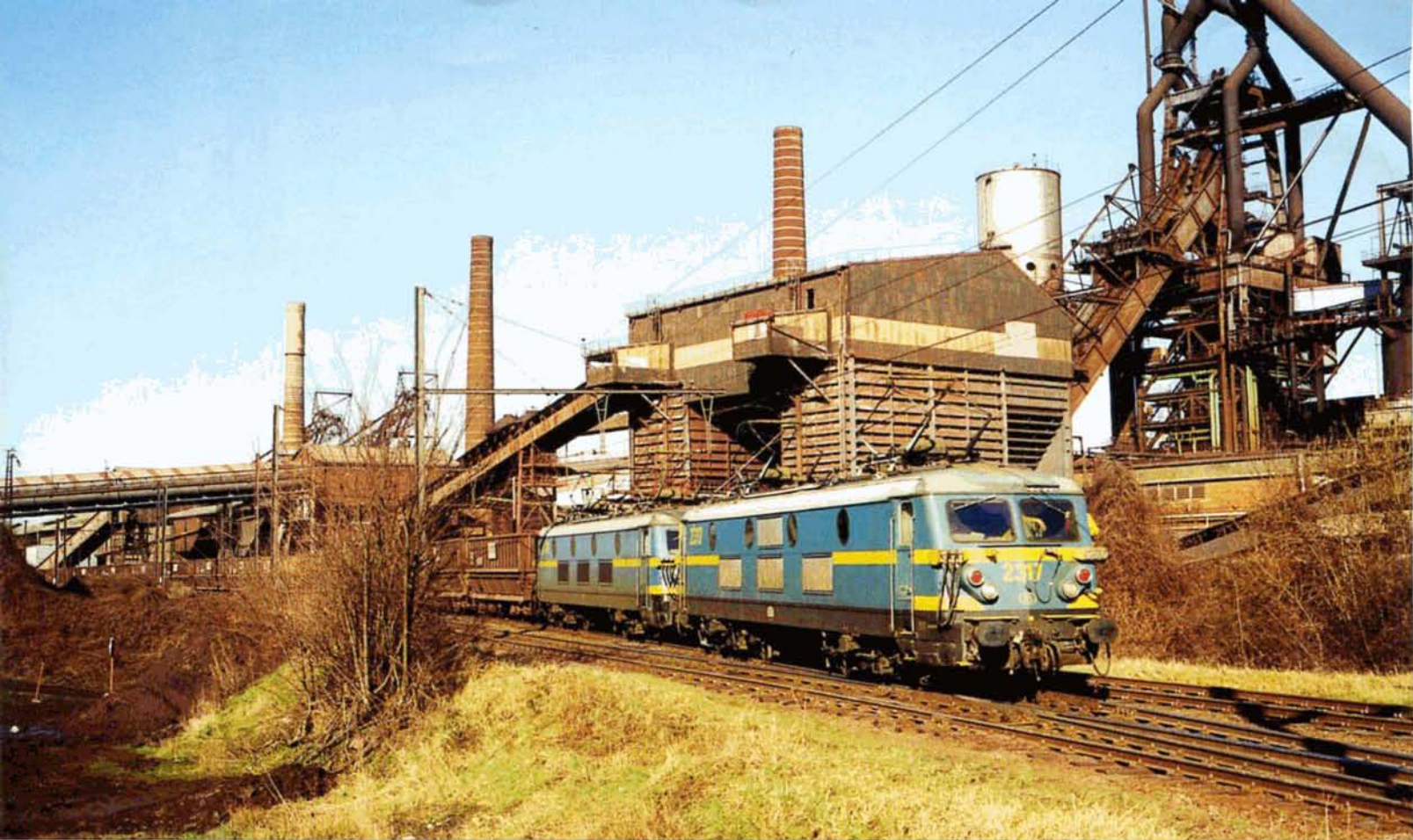
PHOTO 49-52 Le 11 février 2000, arrivée d'un train de minerais remorqué par les 2317 et 2378. Derrière les machines, on voit le site d'arrivée et de chargement du minerai et du coke dans les deux bennes qui seront hissés au sommet du haut fourneau à l'aide d'un funiculaire.
