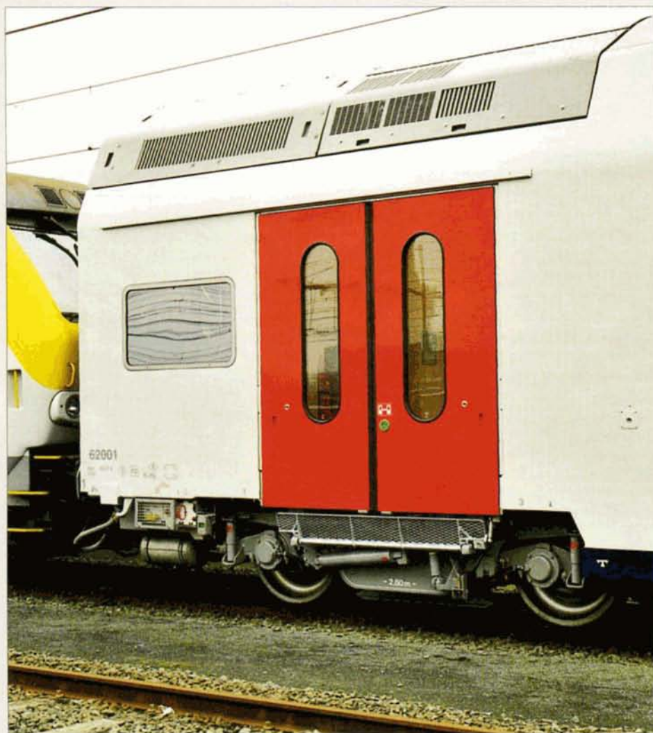
PHOTO 49-34 Gros plan sur une des plates-formes d'accès, avec sa large porte à doubles vantaux. Au-dessus des portes, dans la toiture, se trouvent le convertisseur statique (à gauche) et le groupe de climatisation (à droite). Ces équipements se retrouvent au-dessus des deux toitures. Un petit compartiment de 8 places assises est situé à l'extrémité 1 de la voiture.
