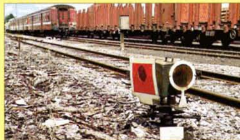
PHOTOS 49-41 et 49-42 En gare de Gouvy, il subsiste deux signaux d'arrêt simplifiés à fleur de sol, protégeant l'entrée et la sortie de la remise. Jean-Luc VANDERHAEGEN.
