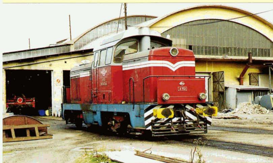
PHOTO 49-21 En 1972, Faur en Roumanie livra une série de 12 BB à transmission hydraulique : les A-151 à A-172, de 507 kW, dont des exemplaires semblables sont en service en Roumanie et Hongrie. Une seconde série similaire, de 550 kW, fut livrée en 1979 : les A-171 à A-177. La A-152 au dépôt de Volos, le 31 décembre 2000. Philippe DE GIETER.
