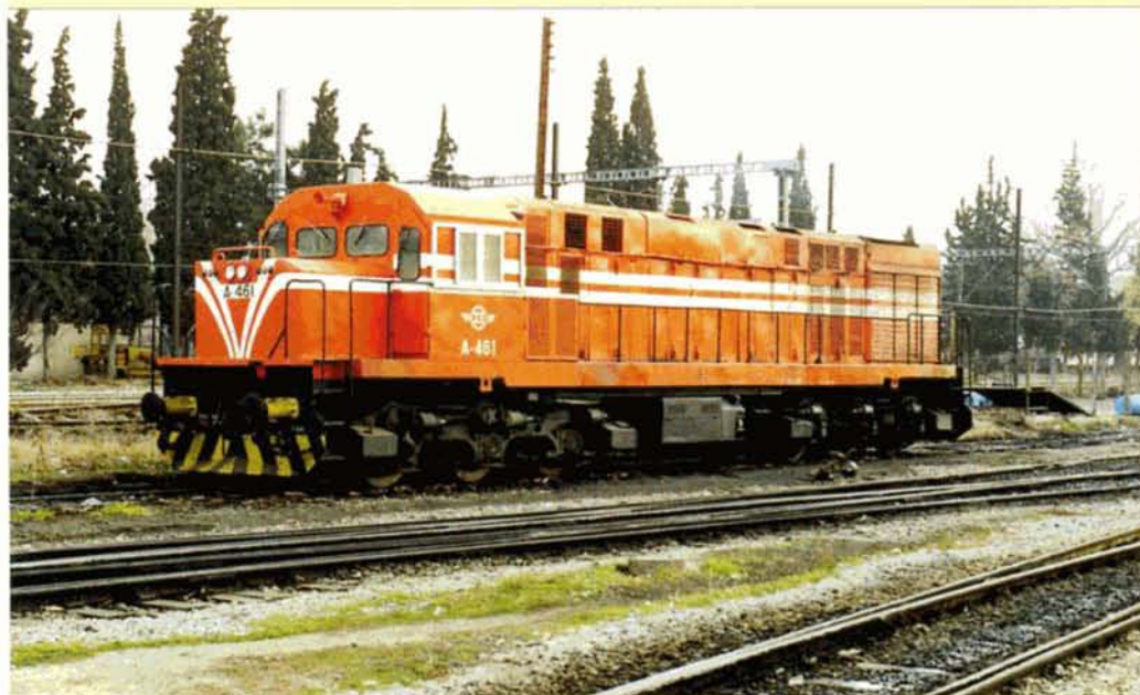
PHOTO 49-17 De 1973 à 1974, la Montreal Locomotive Works au Canada, livra une série de 20 grosses CC de 2000 kW. D'une masse de 120 t, ces machines, numérotées A-451 à 470, peuvent atteindre 130 km/h. Le 29 décembre 2000, la A-461 stationne au dépôt de Thessalonique. La partie avant de cette locomotive a été modifiée par la réduction de la hauteur du petit capot de manière à améliorer sensiblement la visibilité. Ph. DE GIETER.
