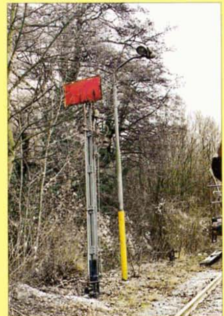
PHOTO 49-84 Le signal d'arrêt simplifié surélevé R d'Aisemont (ligne 150). Jean-Luc VANDERHAEGEN.
