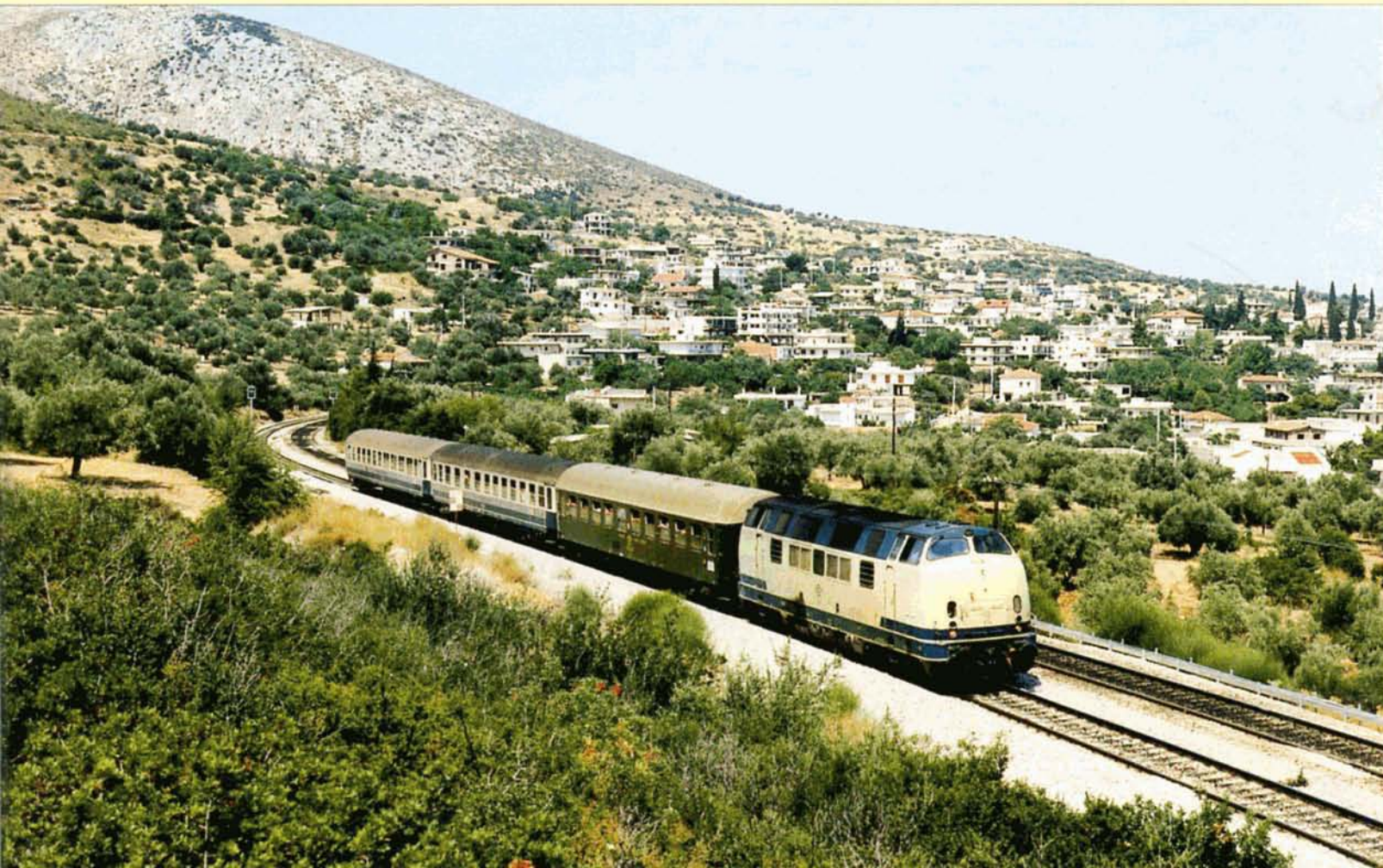
PHOTO 49-19 En 1989, les OSE ont racheté d'occasion à la DB une série de 20 célèbres locomotives diesel-hydrauliques du type V200.1. Ces machines, numérotées A-411 à A-430 et utilisées principalement sur la magistrale Athènes - Thessalonique, ont posé pas mal de problèmes, si bien que moins de dix ans plus tard, toutes étaient réformées. Le 5 août 1996, le train 1511 Larissa - Pirée, tracté par la A-414 (ex. 221.129-0 de la DB, Krauss-Maffei 19249/1965), quitte Avlona en direction d'Athènes. Jean-Luc VANDERHAEGEN.
