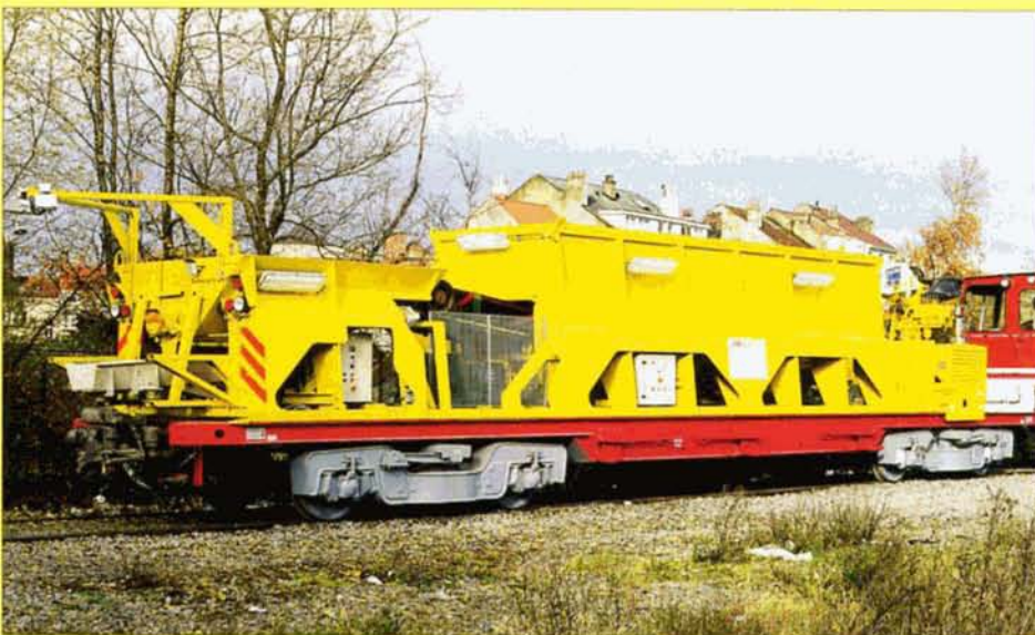
Fraîchement livré par la firme CFD-Locorem et avant d'être remorqué vers le complexe Demets où sont regroupés les trains de travaux du métro, le wagon 73 destiné à la manutention de ballast, est garé sur le raccordement SNCB/STIB à proximité de la station Beekkant, le 1er décembre 2001. Cette vue de l'extrémité 2 nous permet de découvrir le bac déverseur de ce wagon.
