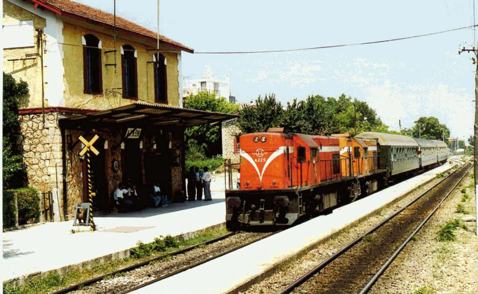
PHOTO 49-20 Arrivée à Avlona du train 1511 Larissa - Pirée, remorqué par les A-225 et A-224. Ces locomotives font partie d'une série de 13 machines construites par General Electric en 1973. Numérotées A-221 à A-237, ces petits engins de 700 kW sont limités à 109 km/h. Il ne subsiste aujourd'hui plus que trois A-220 en activité. Jean-Luc VANDERHAEGEN.
