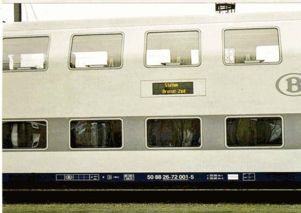
PHOTO 49-33 Un afficheur de destination est placé au milieu de chaque paroi latérale. On remarquera la différence de grandeur des fenêtres des deux niveaux.
