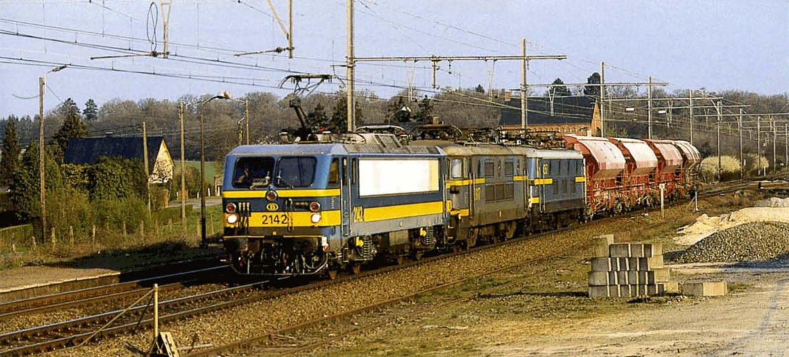
*Toutes les locomotives électriques sortant de révision de l'Atelier Central de Salzinnes, sont testées en ligne, généralement en tête du train 66510 entre Ronet et Jemelle. Le 4 avril mars dernier, la 2142 sortant de RIK2, assure son parcours d'essai, ici en passage à Haversin. Les deux machines remorquant normalement ce train sont placées en véhicule.*
