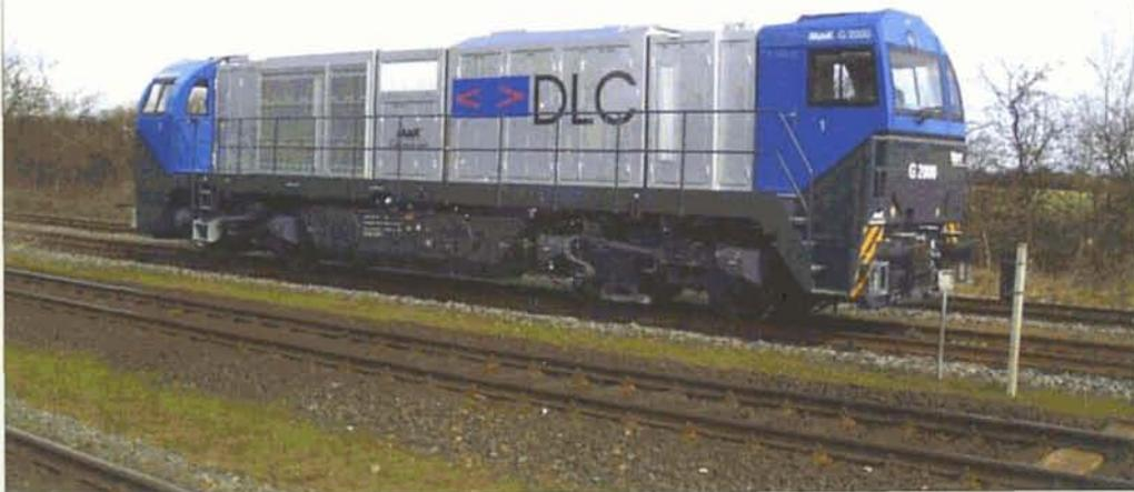
Pour remorquer le train entre Nürnberg et Wackersdorf, DLC utilise une locomotive diesel-hydraulique du type G2000 de Vossloh, vue ici à Neu Wittenberg près de Kiel. Apparue en septembre 2000, ces curieuses machines, bien que petites, sont très puissantes, équipées d'un moteur Caterpillar 3516 B-HD développant 2240 kW. Vossloh a en outre demandé à la SNCB l'homologation des G2000 pour leur circulation en Belgique. Ajoutons encore que les CFL ont testé une G2000 en novembre 2001. Photo DLC.
