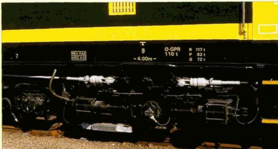
Les nouveaux marquages UIC apposés sur le bas de la caisse de la 5523. Ci-dessus, de gauche à droite, le n° de la roue, la date de révision, le point de levage + n° de roue + empattement du bogie, le régime de freinage et les poids freins. Ci-dessous : le point de levage + n° de roue + empattement du bogie, la longueur totale, l'entraxe des bogies, les réseaux où la circulation est autorisée, et l'indication que l'eau du moteur Diesel est traité au RD25.
