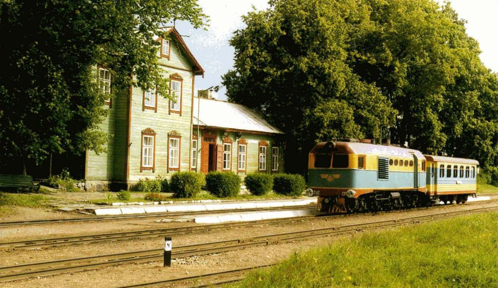
**PHOTO 50-23** En Lituanie, le 22 août 1998, un train composé d'une unique voiture remorquée par la Ty2-131 stationne devant la pittoresque gare de Anyksciai. Ces locomotives à transmission électrique sont équipées d'un moteur Diesel de 260 kW. Philippe DE GIETER.
