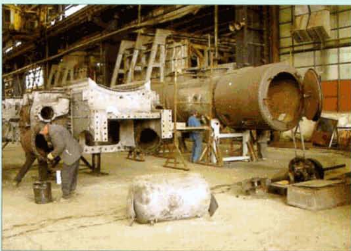
Les travaux à la chaudière et au châssis de notre P8 avancent à grands pas. 25 septembre 2002.
