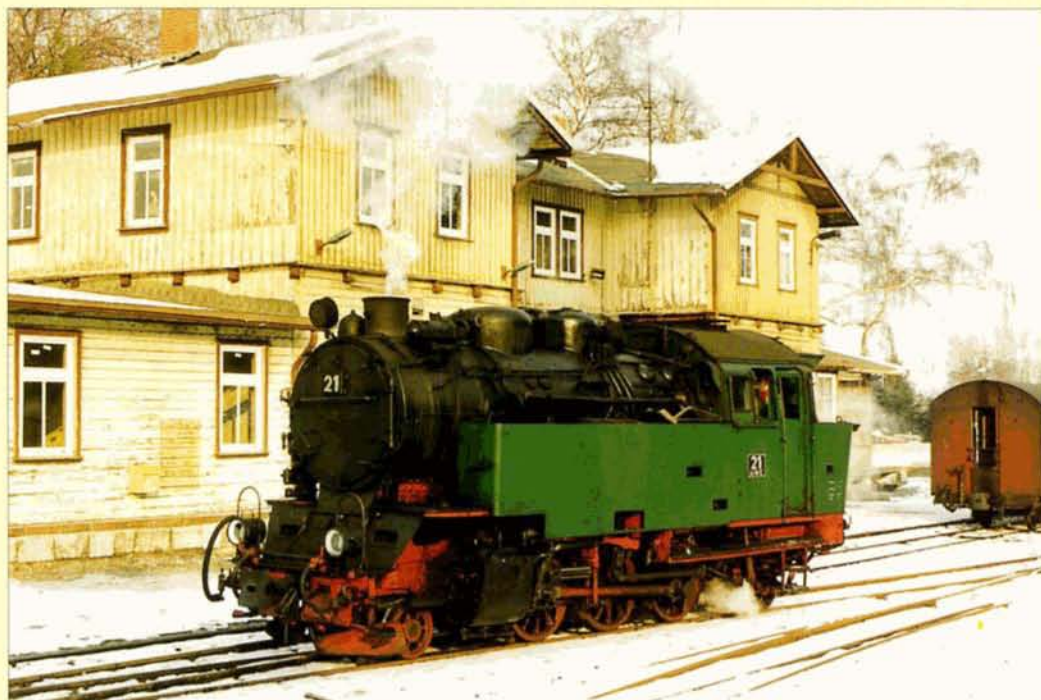
La 1-3-1 T n° 21 du HSB en gare de Hasselfelde. Cette machine fut construite en 1939 par Krupp (n° 1876) pour le Nordhausen-Wernigerode Eisenbahn, où elle portait le n° 21. Lors de la reprise du NWE par la DR en 1949, elle reçut le numéro 99 6001. Le 1er janvier 1992, la DBAG lui attribua le numéro 099 120. C'est en 1993 qu'elle fut remise dans son état d'origine. Philippe GOUSSET, janvier 1998.
