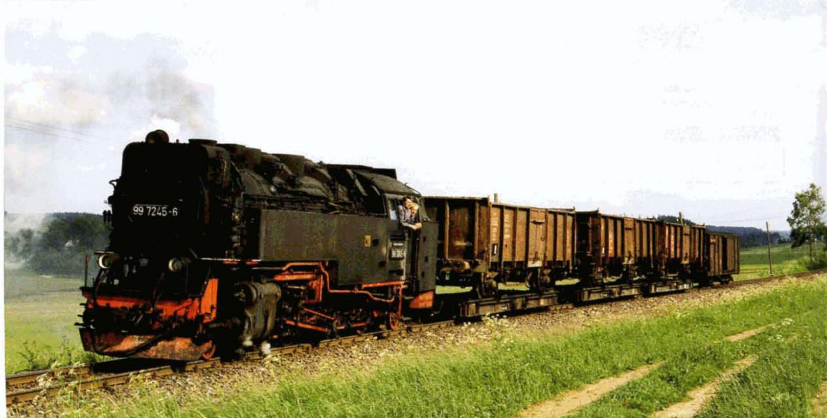
PHOTO 52-59 La 99 7245-6 (ex. 99.245, Karl Marx Locomotivbau 134.022 / 1954) en tête d'un train de marchandises transportant des wagons à voie normale sur des trucks porteurs, photographiée entre Stiege et Hasselfelde, en mai 1982. Pierre HERBIET.
