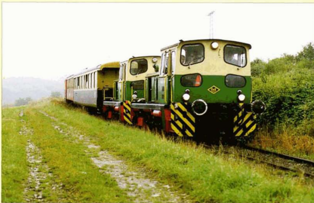
PHOTO 52-63 Toujours sur le Brohltalbahn, les locomotives D1 (O&K 26528 / 1965) et D2 (O&K 26529 / 1965) remorquent le "Vulkan Express" en direction de Brohl. On remarquera que les machines sont pourvues de tampons permettant de manoeuvrer des wagons à voie normale. Brenk, 8 septembre 2002. Philippe DE GIETER.
