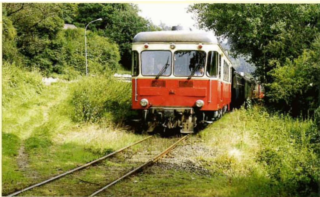
PHOTO 52-62 Le "Vulkan Express" permet de découvrir la ligne. Le plus souvent, il est assuré par l'autorail VT30. Le 8 septembre 2002, il vient de quitter la gare de Burgbrohl et se dirige vers Engeln. Cet autorail à bogies (Bo'Bo') construit par Fuchs en 1956 (n° 9053), est propulsé par 4 moteurs Diesel Büssing de 125 kW. Originaire du réseau à voie étroite du WEG (ligne Amstetten - Laichingen), il fut acquis par le BSEG en 1987. Ph. DE GIETER.
