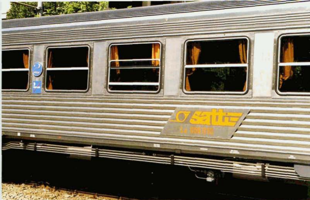
Gros plan sur la paroi latérale. On remarquera les nouvelles fenêtres et le sigle SATTI accompagné du numéro de l'automotrice. Lars LAENEN.
