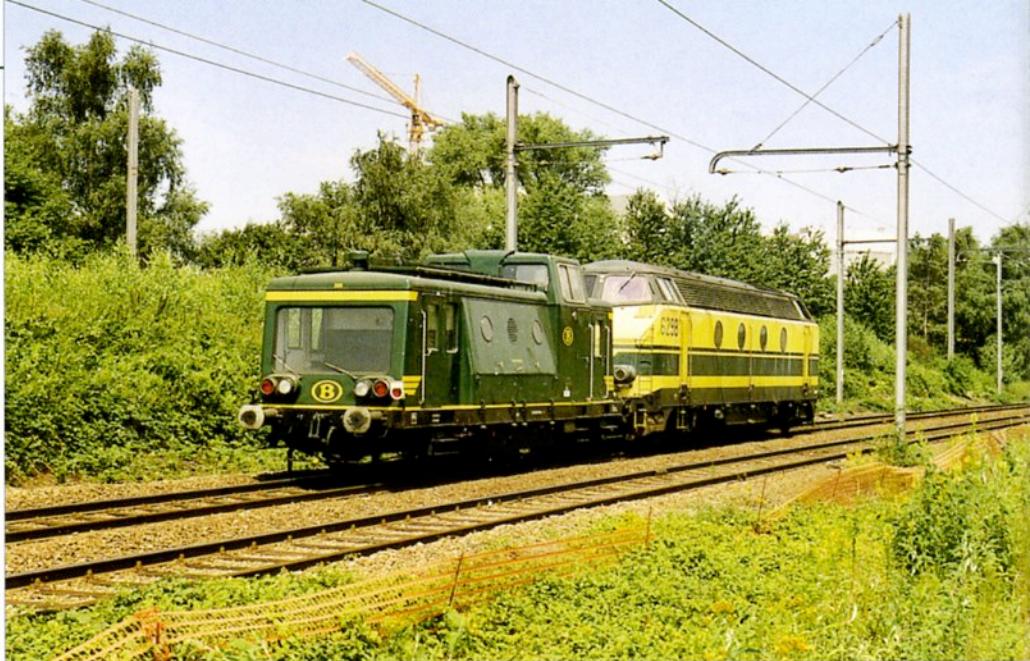
PHOTO 52-32 La draisine 205 préservée par le Patrimoine Historique de la SNCB a quitté l'atelier de Schaerbeek à destination de l'abri d'Haine-St.Pierre, remorquée par la 6298. Ce véhicule fut construit par l'Atelier Central de Luttre en 1963 et servit comme engin d'inspection des voies. En 1973, la draisine fut entièrement modernisée à l'Atelier Central de Mechelen. Schaerbeek, 17 juillet 2002. Jean-Luc VANDERHAEGEN.
