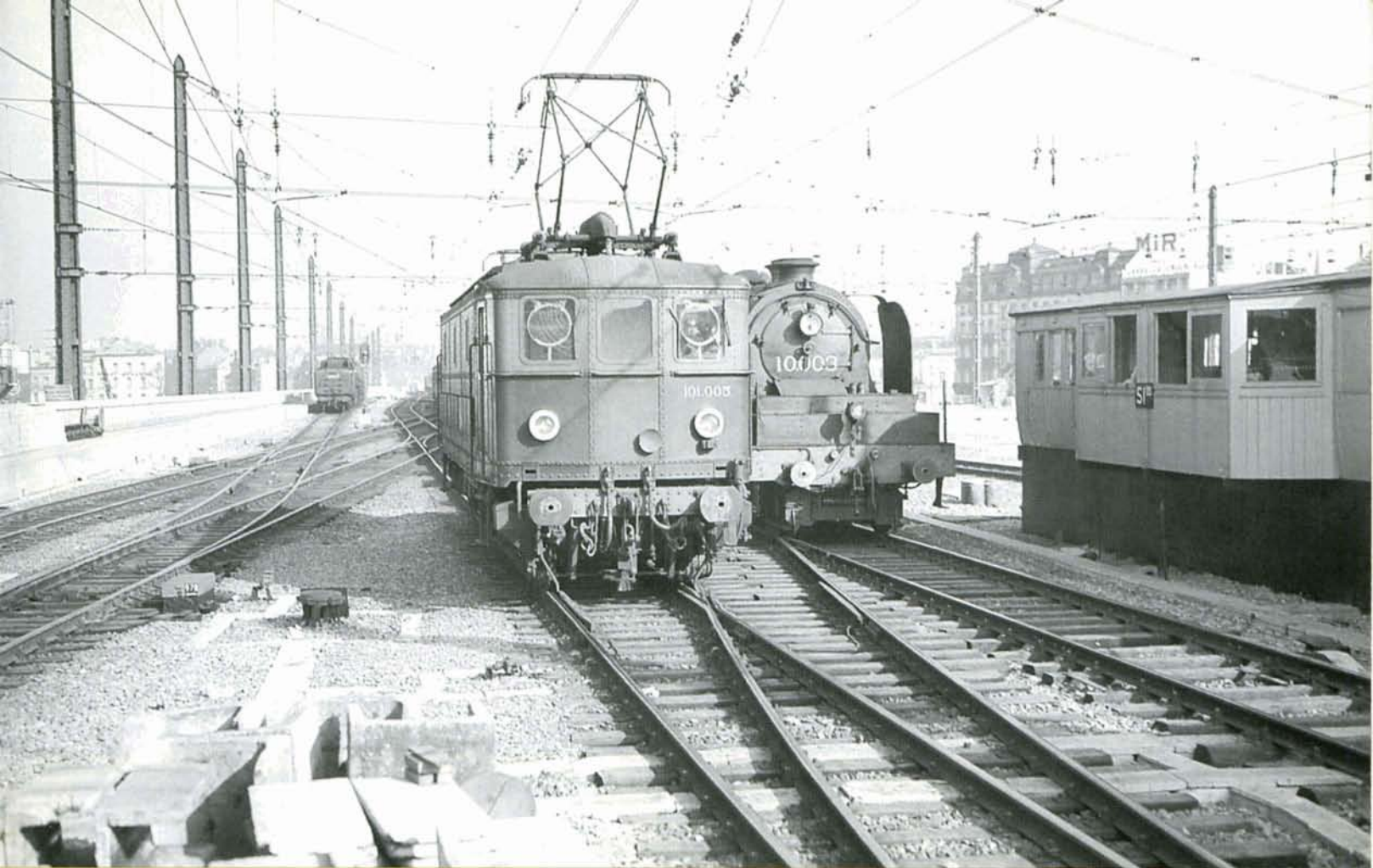
PHOTO BD-150 La locomotive électrique 101.005 effectue un service d'allège et va se placer en tête d'un train qui empruntera la Jonction. A hauteur du block provisoire 1bis, elle dépasse la 10.003. Dans le cul-de-sac qui court jusqu'au viaduc du boulevard du Midi se trouve une Pacific type 1. Bruxelles-Midi, décembre 1952. Bruno DEDONCKER; collection : PFT.
