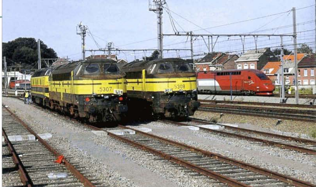
Lors des premiers essais des Thalys sur la LGV2, deux couplages formés d'une 55 TVM (muni de l'attelage de secours) et d'une 53, étaient mobilisés à Ans pour parer à tout incident en ligne. Ans, 16 septembre 2002. Michel HANSENS.
