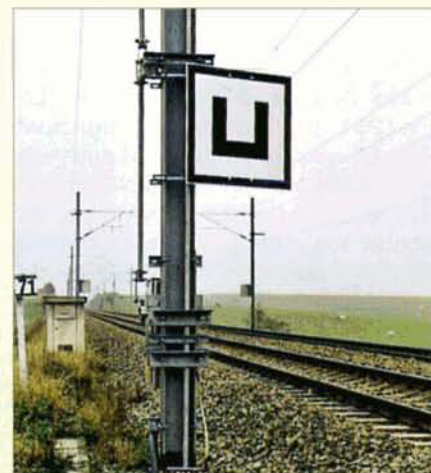
De gauche à droite : le panneau d'annonce d'une zone à franchir sans prélèvement de courant, le panneau d'origine de la zone, le panneau de rétablissement. Burhaimont, 19 novembre 2002. Jean-Luc VANDERHAEGEN.
