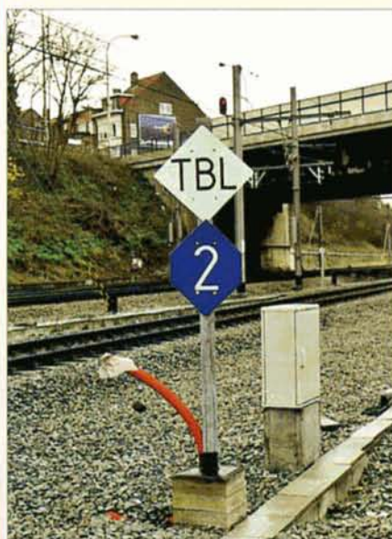
A gauche, le panneau TBL placé sur le mât des signaux pouvant donner accès à une ligne équipée de la TBL. A droite, le panneau TBL implanté à l'entrée des lignes exclusivement équipées de la TBL. Leuven, 28 novembre 2002. Jean-Luc VANDERHAEGEN.
