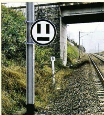
De gauche à droite : le panneau d'annonce d'une zone à franchir sans prélèvement de courant, le panneau d'origine de la zone, le panneau de rétablissement. Burhaimont, 19 novembre 2002. Jean-Luc VANDERHAEGEN.
