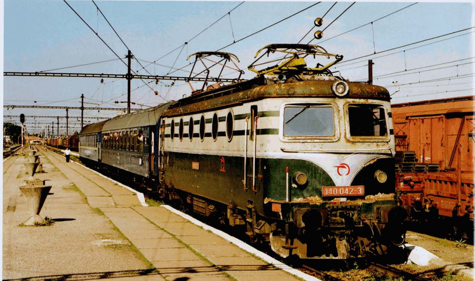
PHOTO 57-47 Après la longue halte à la frontière slovaque à Cierna nad Tisou, la 140.042-3 des Chemins de fer slovaques (ZSR) nous conduira jusqu'à Chop en Ukraine. Ce type de locomotives fut construit à 100 unités de 1953 à 1958 par Skoda (2032 kW - 3000 V). VDH.
