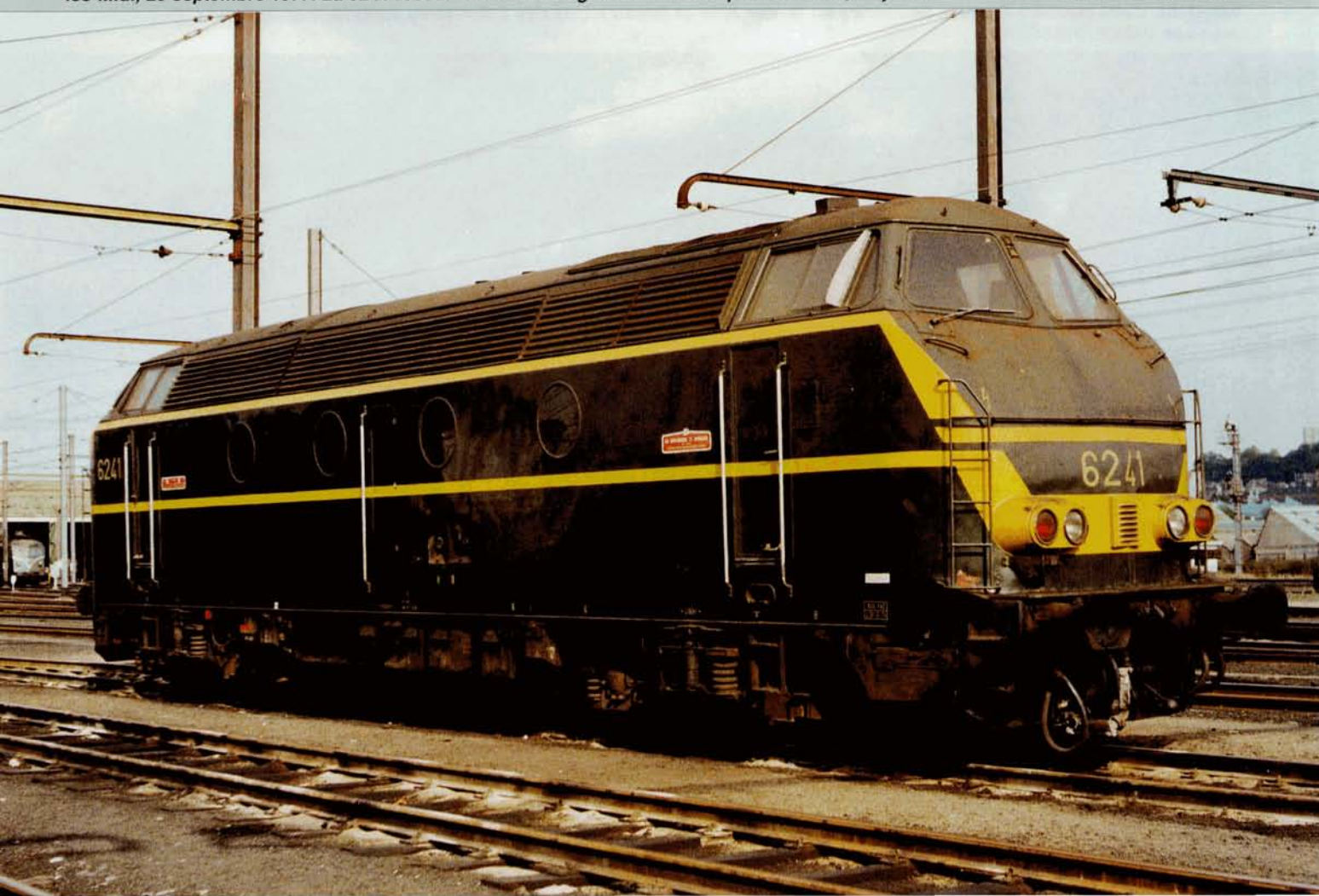
PHOTO-THEME 54 La 6241 du dépôt de Saint-Ghislain (Tournai) portait une robe transitoire avec élargissement réduit et dont la ligne jaune se trouvant sur ses faces avant n'était pas raccordée à la ligne descendant du haut de la caisse (variante 3-3). Atelier de Bruxelles-Midi, 29 septembre 1977. La 6241 ressortit de révision générale le 30 septembre 1987, en jaune. Jean-Luc VANDERHAEGEN.
