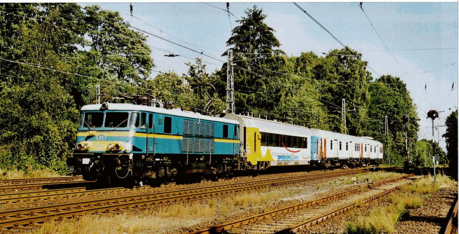
PHOTO 58-66 Le 18 septembre 2003, le train de mesures s'est rendu à Aachen-Hbf, toujours remorqué par la 1503. Celle-ci est spécialement équipée de deux pantographes comportant des repères permettant à la caméra de la voiture 00800 de contrôler le désaxement des caténaires. Le train arrive ici à Aachen-Süd, lors de son retour vers Schaerbeek. Pierre HERBIET.
