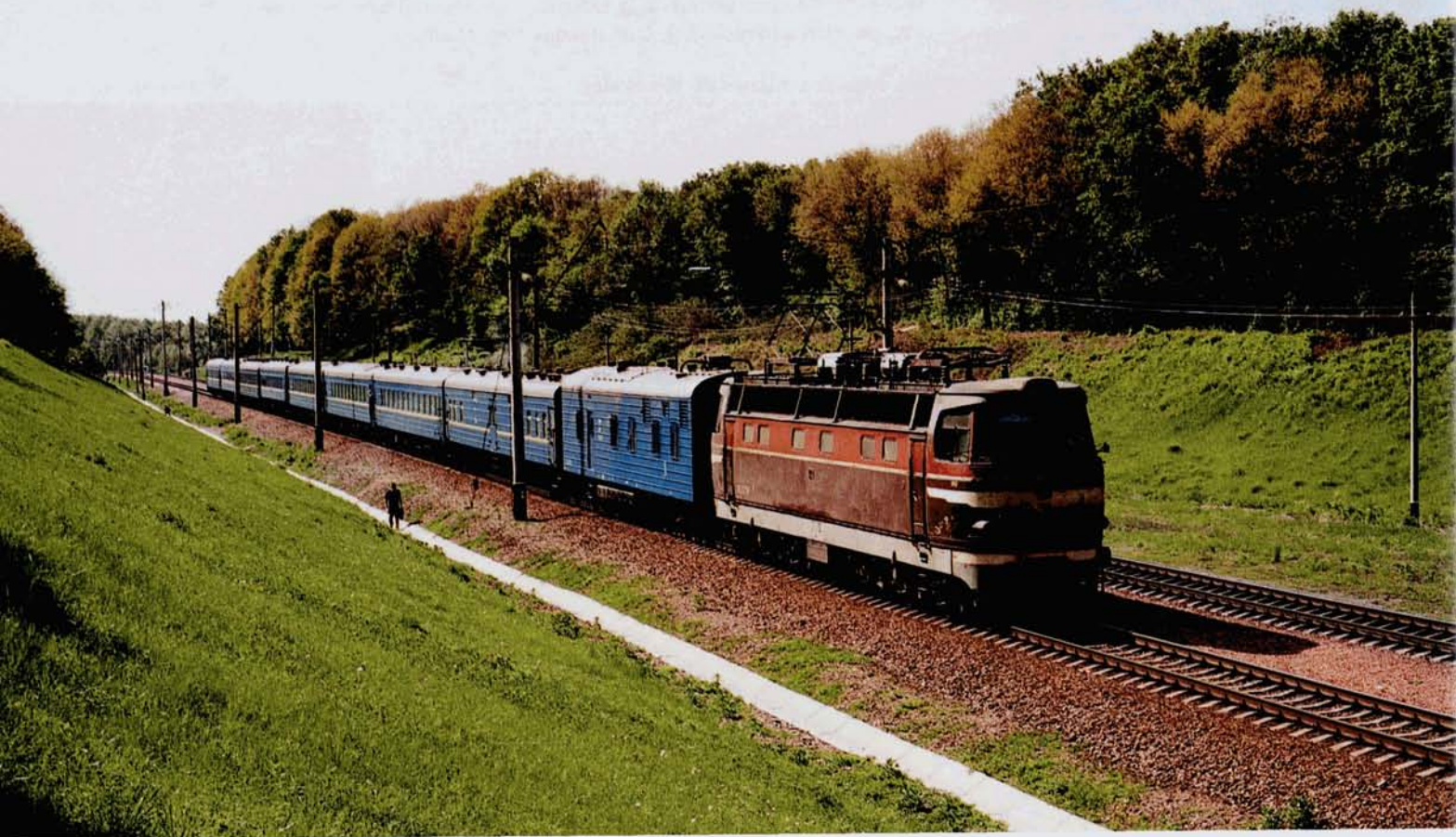
PHOTO 58-10 Le 18 mai, notre train fut remorqué entre Kiev et Grebenka par la ChS4-075. Cette série de 230 engins fut également produite par Skoda, de 1966 à 1972. Leur puissance atteint 5100 kW et leur masse s'élève à 123 t. Derrière la locomotive : le fourgon, la voiture douche-sauna, la voiture-lits pour le personnel, les deux voitures-restaurants, la voiture bar-salon et les trois voitures-lits du PFT.
