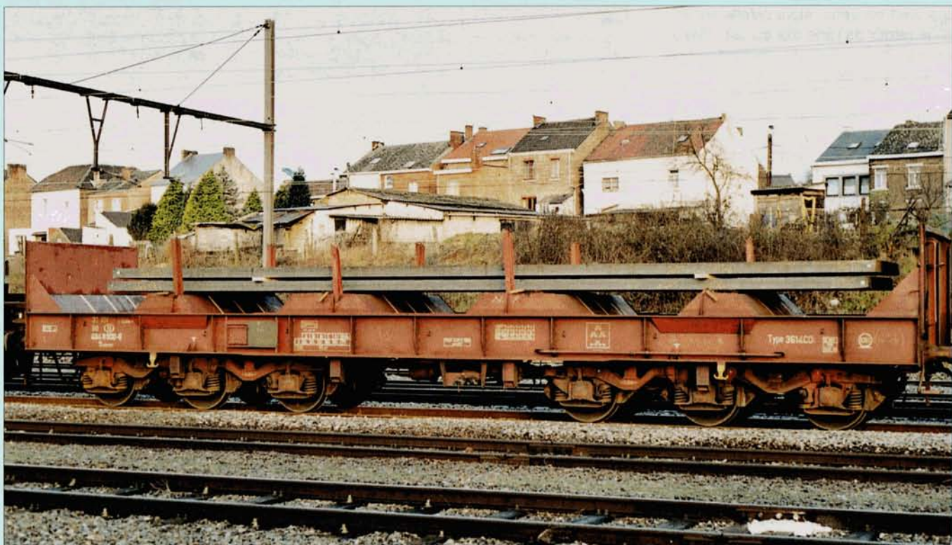
PHOTO 58-41 Le Sammps type SNCB 3614C0 à Ronet. Ce wagon peut transporter indifféremment des brames ou des coils. Jean-Luc VANDERHAEGEN.
