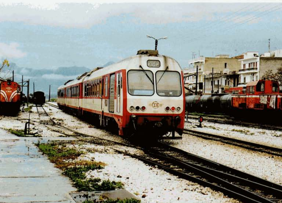
PHOTO 58-56 En gare de Corinthe, le 1er janvier 2001, départ de l'IC 21 Pirghos - Le Pirée, assuré par l'autorail triple 1503 + 5503 + 6503. Sur cette série d'autorails, seules les voitures 5500 et 6500 sont motrices, équipées chacune d'un moteur Diesel MAN de 398 kW et d'une transmission hydraulique. Vitesse maximale : 100 km/h. Philippe DE GIETER.
