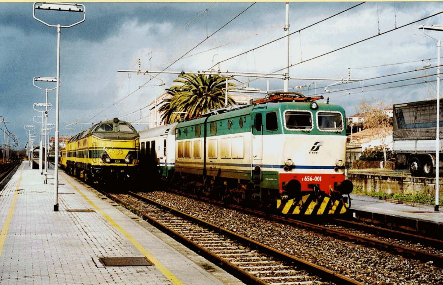
PHOTO-THEME 59 En gare de Nocera Tirinese, les deux locomotives belges croisent un express tracté par la E656-001. Les E656 sont des locomotives typiquement italiennes, à deux caisses articulées sur trois bogies. Elles furent produites à 608 unités de 1975 à 1989 et sont en grande partie responsables de la disparition des séries anciennes (E321, E428 et E626). Elles développent 4200 kW, peuvent circuler à 150 km/h et pèsent 120 t. Patti FRANCESCO.
