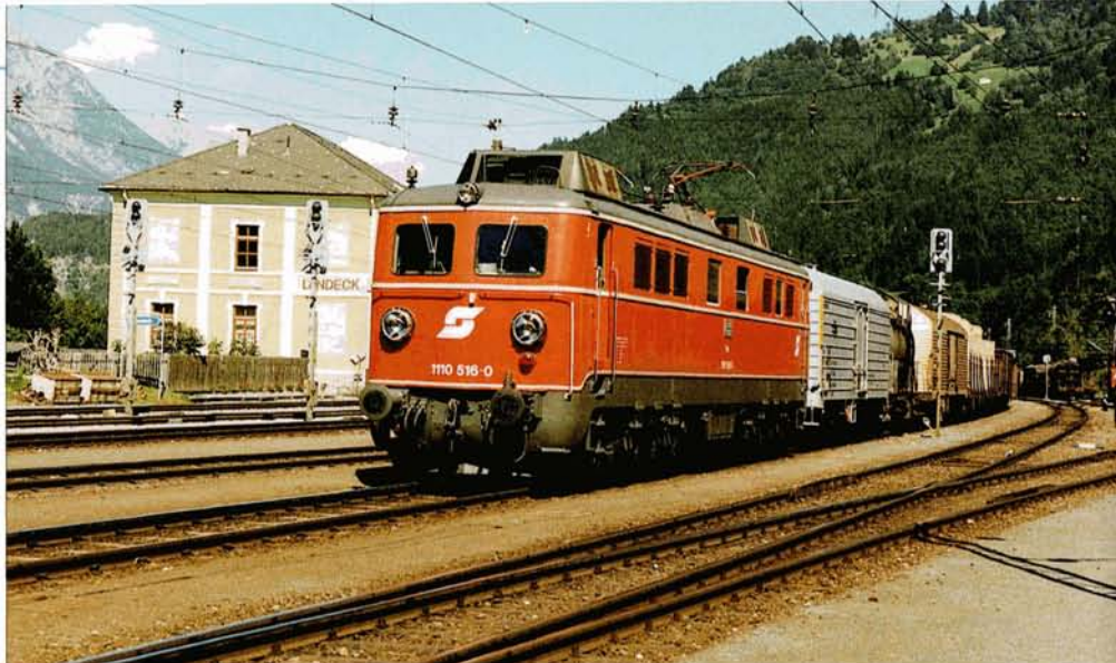
PHOTO 61-61 La 1110 518-7 à Landeck, le 30 août 1987 (+ : 01-06-2002 à Linz). Les 1110.5 étaient reconnaissables aux résistances du frein électrique sur leur toiture. J-L VDH.
