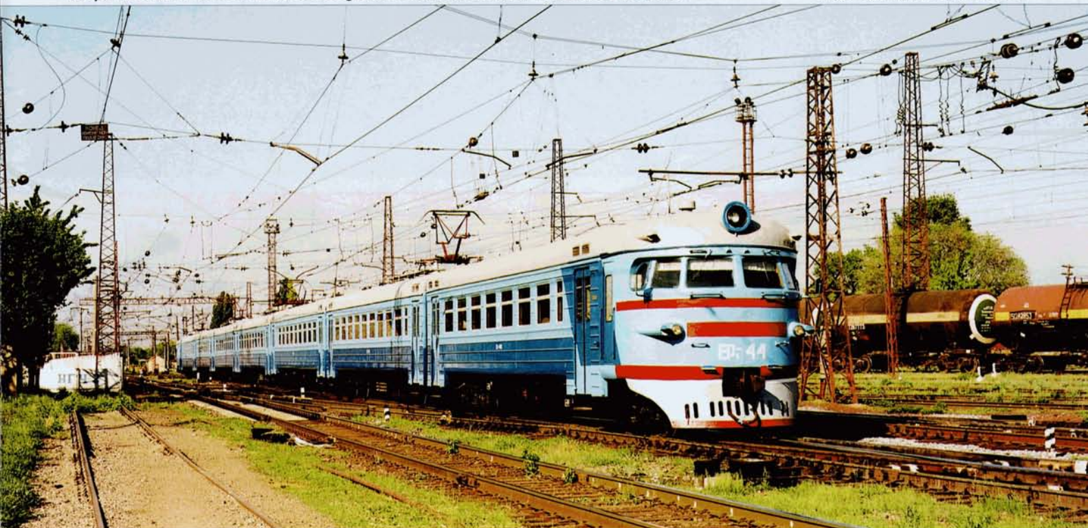
PHOTO 61-05 Le même jour, arrivée à Krivoy Rog de l'automotrice ER1 - 44. Ce matériel fait partie d'une famille de 1487 automotrices typiquement soviétiques, construites par Riga de 1958 à 1976 (types ER1, ER2, ER9 et ER9P - 800 kW - 130 km/h), dont une partie est apte au 3 kV et l'autre au 25 kV. Les ER1 furent produites à 1149 unités (sections de deux voitures). Ce matériel est visible partout dans l'ex. URSS et circule généralement avec un ensemble de 8 voitures. Jean-Luc VANDERHAEGEN.
