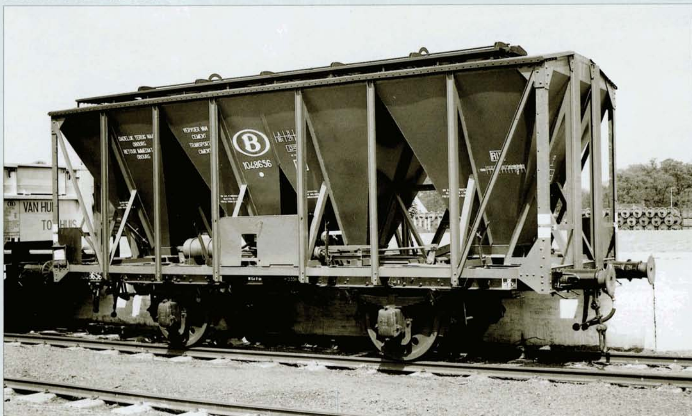
PHOTO BD-176 Le wagon 1.048.656 à Brugge le 9 mai 1960. On remarque fort bien l'ossature, surtout aux parois d'about, qui provenait de la caisse d'un wagon fermé. Ce wagon était utilisé pour le trafic de la cimenterie d'Obourg. Bruno DEDONCKER, collection PFT.
