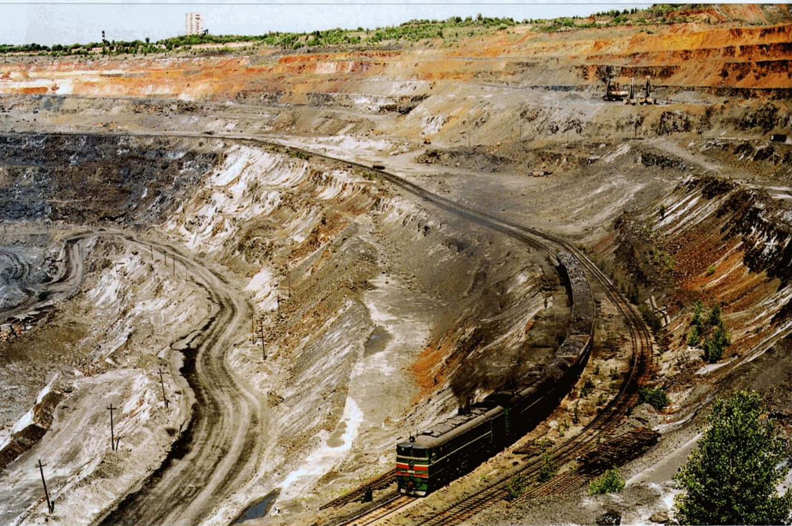
PHOTO 61-02 ↑ - PHOTO 61-03 ↓ Un train de minerais de 1000 t remorqué par une 2TE10M peine pour gravir les pentes de la mine. Sur la photo ci-dessus, la flèche permet de distinguer le train dans l'immensité du cratère. De longues minutes plus tard, il passa à notre hauteur dans le vacarme assourdissant des moteurs Diesel poussés à fond. Ce type de locomotives a été produit par Lugansk à 2172 unités de 1981 à 1990. Ces Co'Co' + Co'Co' développent 4416 kW pour une masse totale de 276 t. Elles peuvent circuler à 100 km/h. Jean-François HUART.
