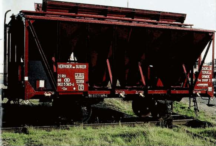
Les wagons Ude furent rapidement utilisés pour le transport diverses marchandises, comme du grain, des engrais, des matériaux pour la production de plastique, de la soude, et même du sucre et des betteraves comme en témoignent ces deux intéressants documents. Ci-dessus : deux Ude photographiés au port d'Antwerpen, utilisés pour le transport de sucre et de soude. Jan FOQUET.
