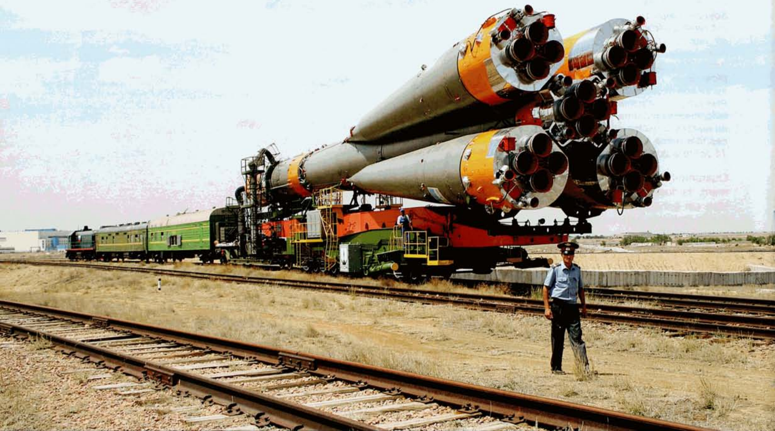
PHOTO 69-38 ↑ - PHOTO 69-39X ↓ La fusée Soyuz-U transportant le satellite scientifique Foton-M2 avec 39 expériences de l'Agence Spatiale Européenne, est poussée par la TEM2UM-179 vers son pas de tir sous la surveillance d'un soldat précédant à pied.
