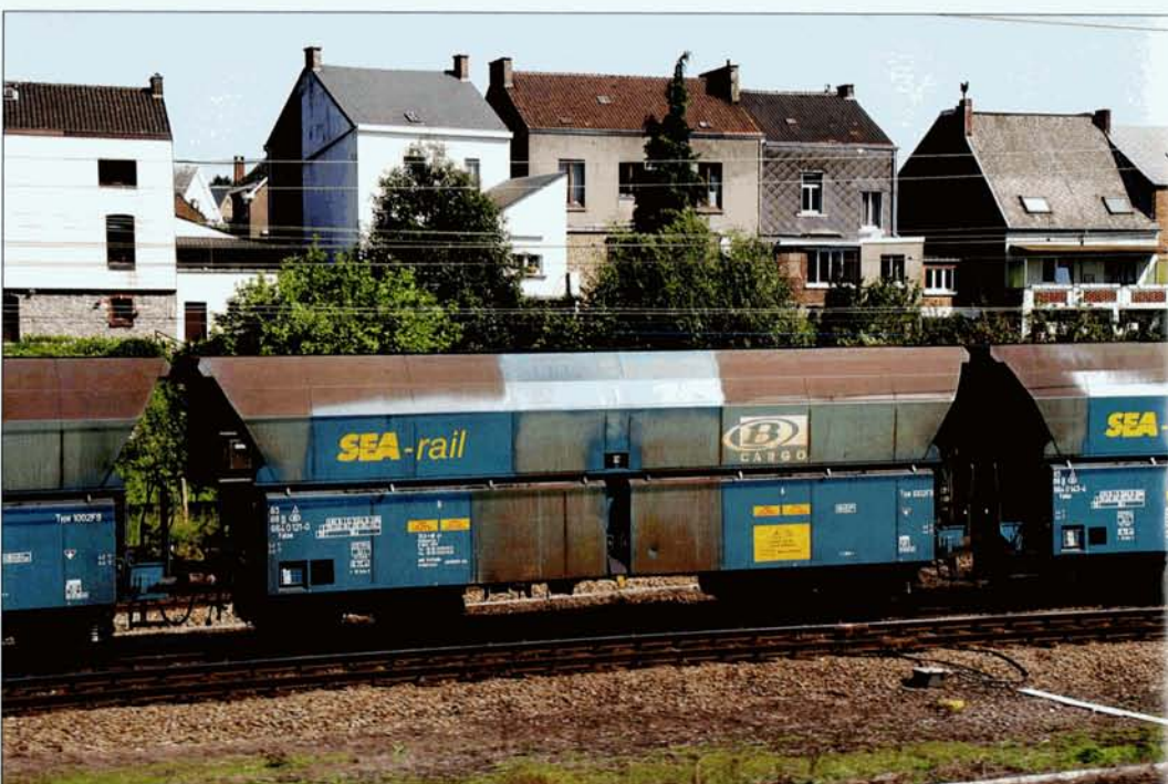
PHOTO 70-29 Les wagons 1002F9 et 1003F9 sont donnés en locations à Sea-Rail et utilisés pour le trafic de charbon vers la Lorraine. Ici, le Falns 1002F9 n° UIC 85 88 664 0 121-0 incorporé dans le train 49813 Antwerpen-Zandvliet - Creutzwald en passage à Ronet le 30 août 2005. On remarquera le dispositif de commande des portes placé sur le côté arrière de la caisse en haut des buttoirs.
