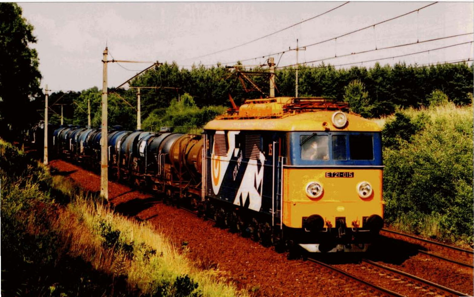
PHOTO 70-23 La ET21-015 (ex. Chemin de fer des sablières de Maszki) de Chem Trans Logistic à Maksymilianowo près de Gdansk, le 7 juillet 2005. Ce type de locomotive a été produit à 726 exemplaires, dont 658 pour les PKP (ET 21.001 à 658) et 68 pour des réseaux industriels (constructeurs PAFAWAG et Dolmel à partir de 1957 sur base des VL22 russes, 2040 kW, 105 km/h, 113 à 120 t). Gregorz KOTLAVZ.
