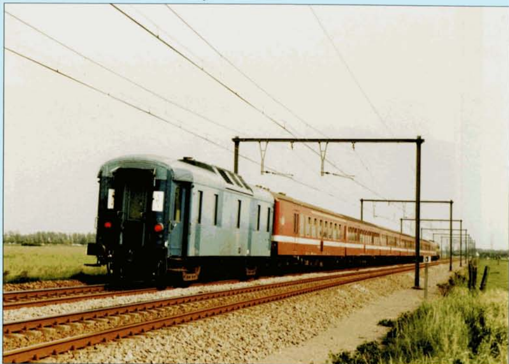
PHOTO 70-90 Le fourgon-générateur 77020 en queue d'un train touristique, vient de quitter la station balnéaire de Blankenberge et se dirige vers Brugge. Le fourgon est vu côté couloir latéral; les deux portes coulissantes ont disparu, remplacées par deux fenêtres. Jean-Luc VANDERHAEGEN, 18 juin 1984.
