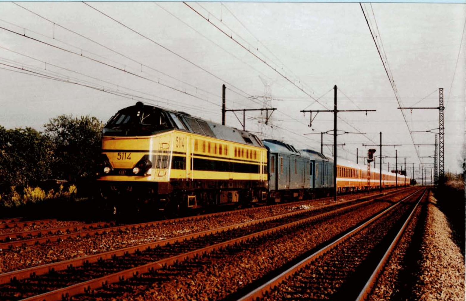
PHOTO-THEME 69 Le 4 mai 1988, sur la ligne 27 entre Duffel et Kontich, passage d'un train spécial en provenance du port de Zeebrugge. La rame, composée de 10 voitures du type I10, était alimentée par deux fourgons-générateurs. Pierre HERBIET.
