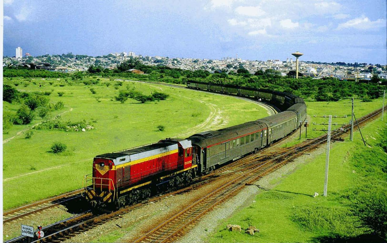
**Le 8 octobre 2004, une rame est manoeuvrée sur un triangle de virage à Santiago de Cuba. En tête, la locomotive 71032 d'origine russe (type TEM-2, construit à 58 unités par Briansk en 1974). Ces Co'Co' développent 760 kW.**
