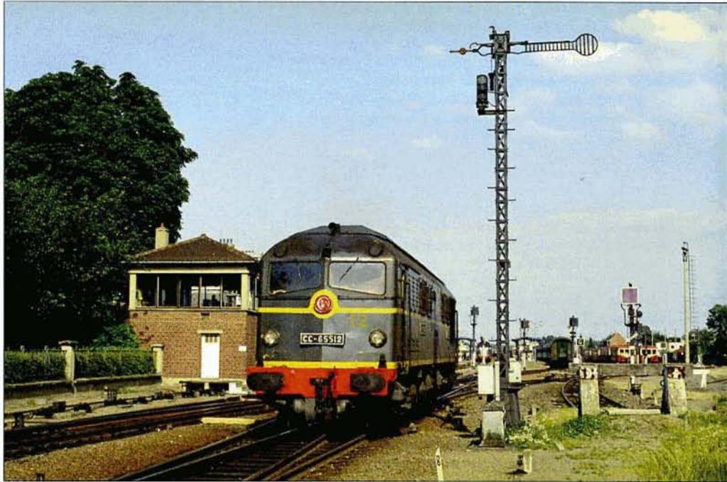
**PHOTO 73-17** Leur esthétique et leur bruit particulier leur ont donné le surnom de "Dakota". Le 1er août 1976, la CC 65512 manoeuvre à Beauvais, gare à ce moment encore équipée de signaux mécaniques "Lartigue". Mise en service le 6 mai 1956, elle sera réformée le 16 février 1983 et vendue à la société Travaux du Sud-Ouest. Philippe DIEU.
