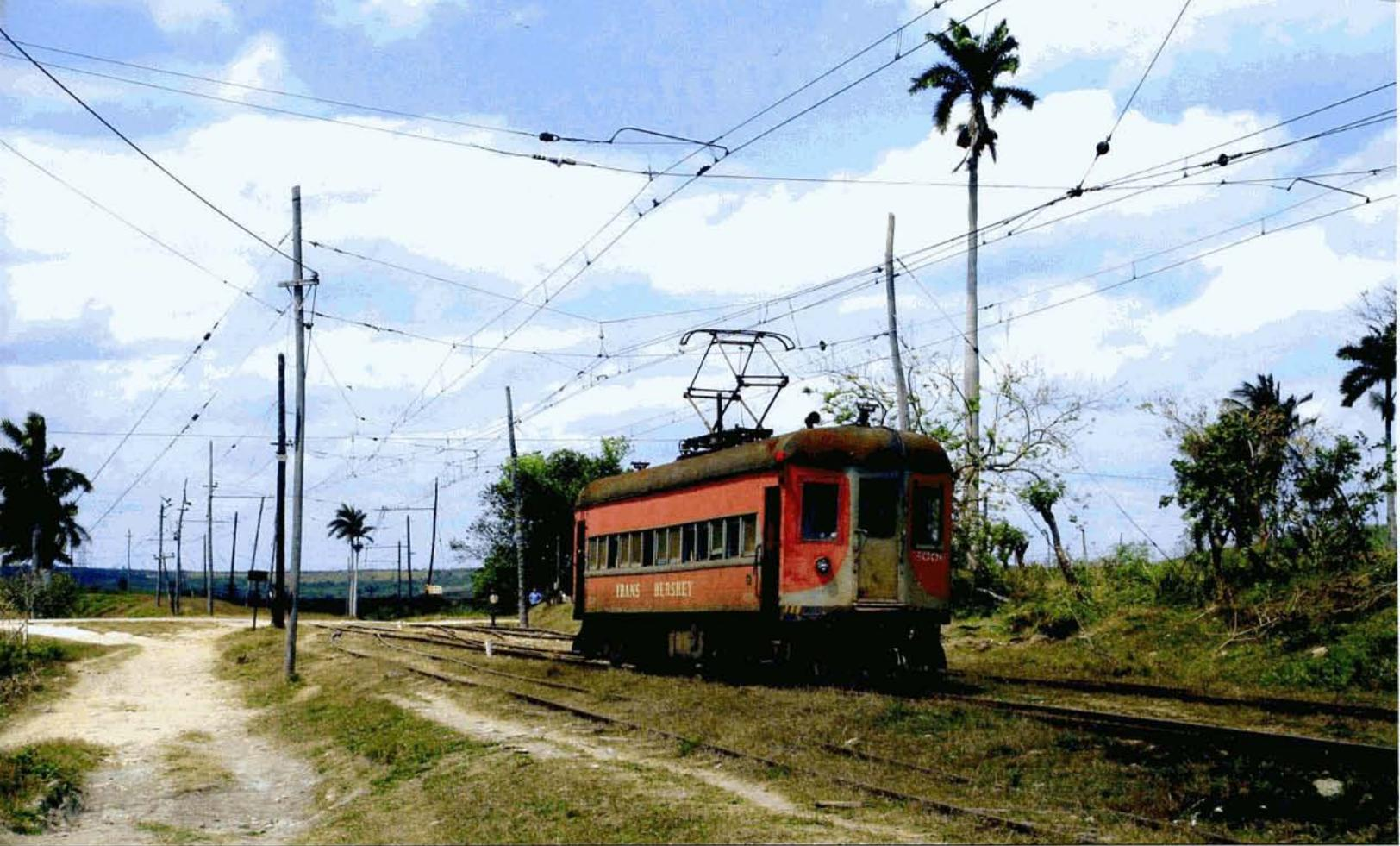
**PHOTO 73-10** Un important réseau suburbain, le tout dernier existant dans le monde, électrifié en 1200 V, est aujourd'hui moribond, faute d'entretien. L'automotrice 3006 est la seule encore active des 11 motrices construites par Brill et General Electric en 1920 (série 3001 à 3011); la voici à Jibacoa, sur la ligne principale de ce réseau reliant Matanzas à Hershey (+/- 90 km). D'une puissance de 220 kW, elle peut circuler à 50 km/h.
