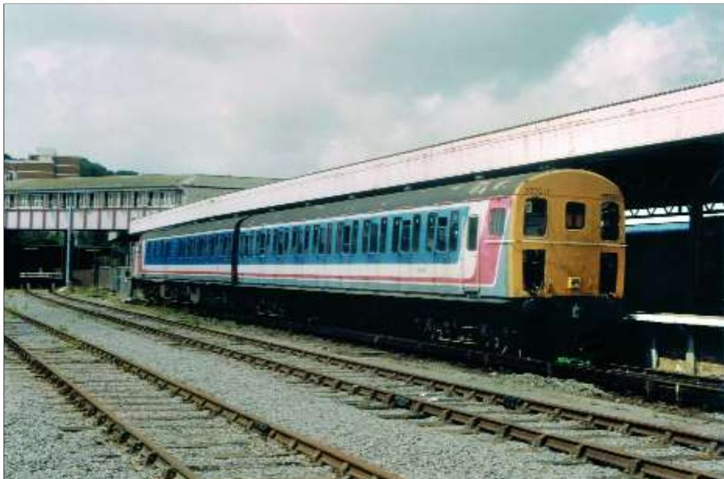
**PHOTO 75-15** Le 21 juillet 1998, l'autorail double 207 017 attend son prochain départ à Hastings. Ces rames ont été construites dans l'atelier BR de Eastleigh en 1962. A l'origine, elles étaient composées d'un élément moteur (moteur English Electric de 450 kW), d'une voiture-pilote et d'une voiture intermédiaire. Philippe DE GIETER.
