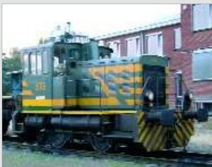
Le locotracteur 9119 de Hasselt, utilisé pour assurer les manoeuvres dans l'atelier, a reçu un nouveau pot d'échappement permettant de réduire la pollution. Ce dispositif assez inesthétique est installé sur la toiture de la cabine. Hasselt, 12 juillet 2006.
