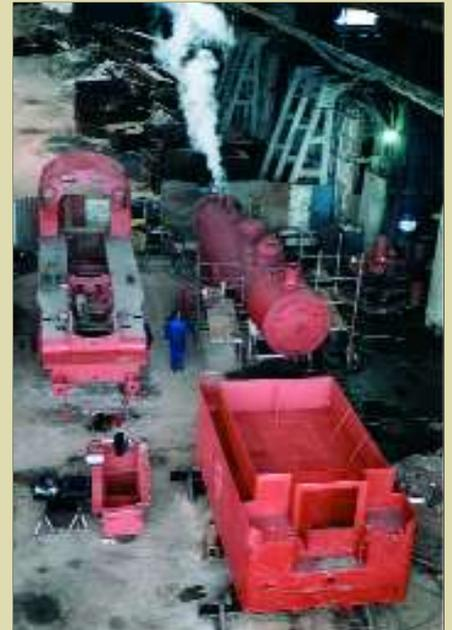
*22 octobre 2003. Première mise sous pression réalisée sous le contrôle d'un délégué d'AIB-Vinçotte. Les soupapes fument.*
