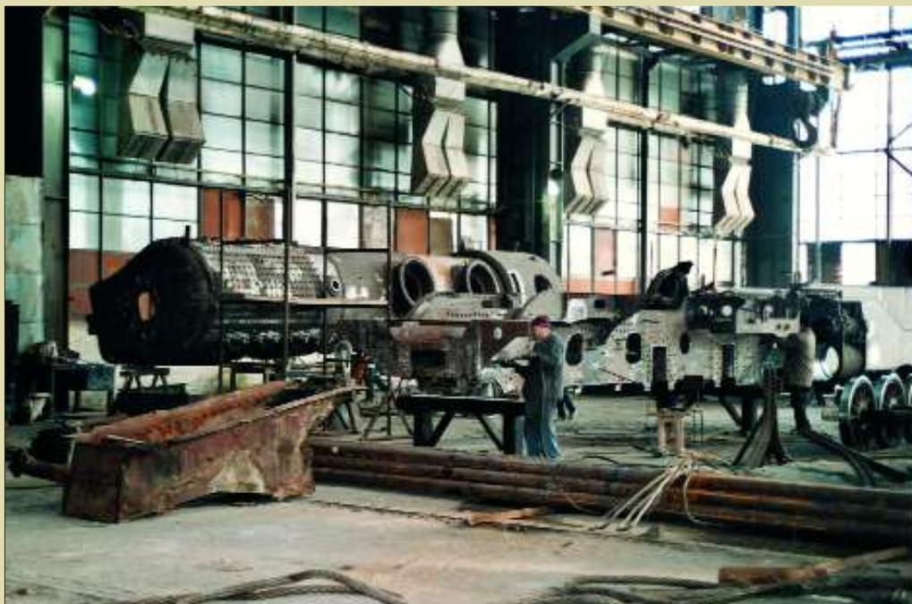
**Après le sablage du châssis, les premiers travaux de remontage pouvaient débuter. A gauche, on voit le cendrier du foyer et, à l'arrière-plan, la chaudière. Novembre 2002.**
