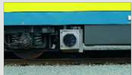
Toutes les locomotives électriques, à l'exception des 22, 23 et 25, sont en cours d'équipement d'un dispositif d'air conditionné des cabines de conduite. Une partie de l'appareillage est disposé sous le châssis des 21/27.
