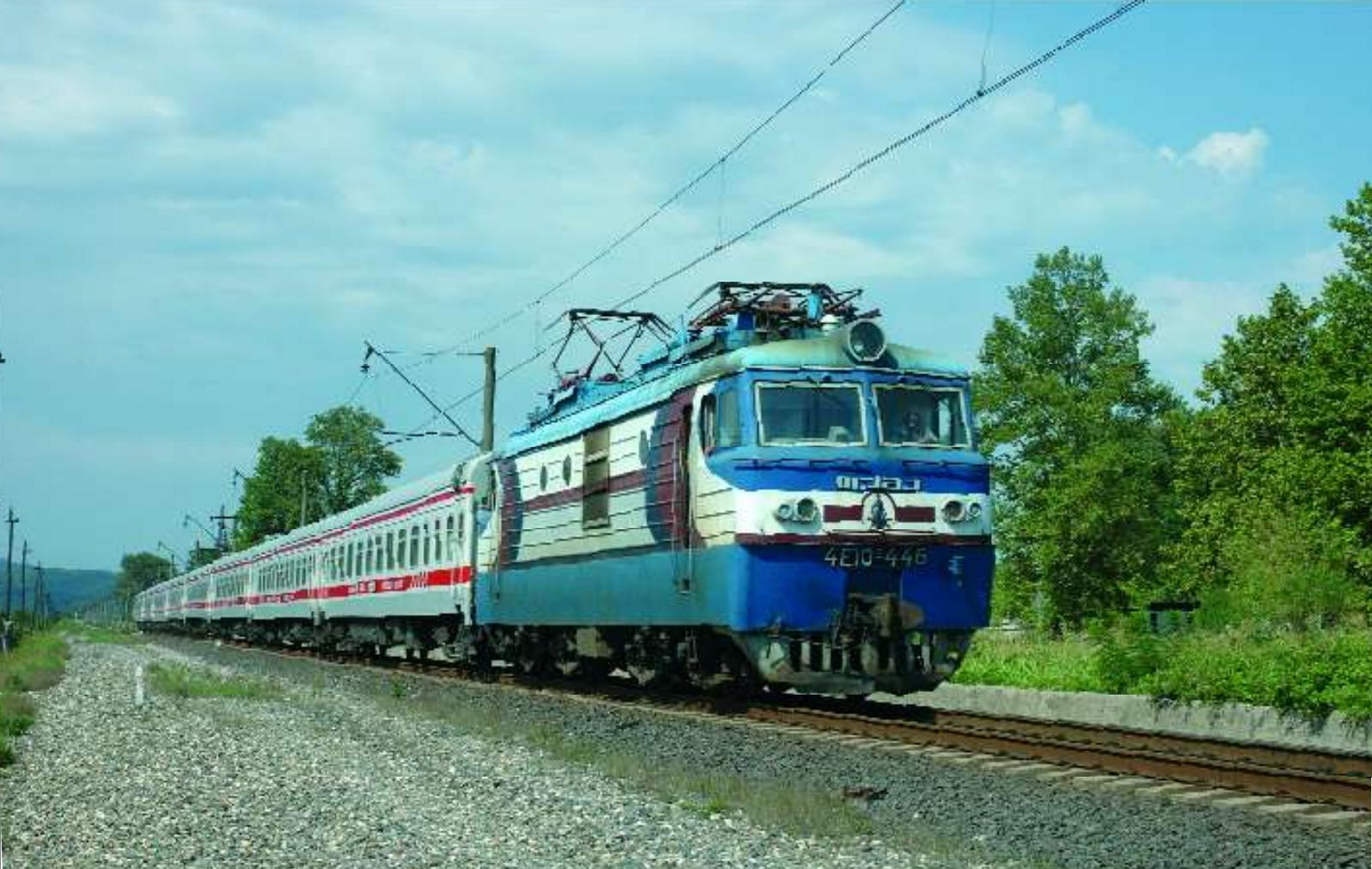
**PHOTO 84-12** ↑ Plusieurs locomotives doubles (Bo'Bo' + Bo'Bo') du type VL10 ont été transformées en machines simples (Bo'Bo'), renumérotées dans la série 4E10. Le 26 août 2007, passage à Sajavakho de la 4E10-446. Cette locomotive arbore les nouvelles couleurs des Chemins de fer géorgiens. Yves STEENEBRUGGEN.
