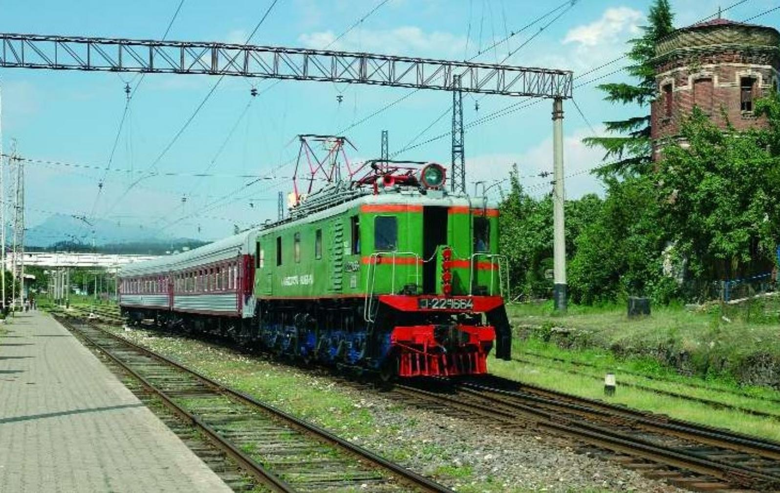
**PHOTO 84-08** Plusieurs vénérables locomotives du type VL22 circulent toujours en Géorgie et passent en révision, comme en témoigne cette vue de la VL22M-1664 en gare de Kutaisi le 26 août 2007. Les VL22M furent construites à 1543 unités de 1941 à 1958. Leur puissance s'élève à 2400 kW pour une masse de 132 t et une vitesse limitée à 80 km/h. Yves STEENEBRUGGEN.
