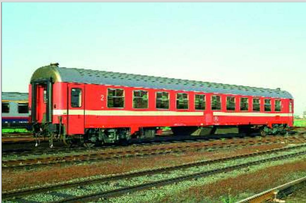
**PHOTO 84-41** La voiture I10 n° 12715 dans la livrée Eurofima orange d'origine. Elle fait partie des 45 voitures de seconde classe non climatisées, série 12701 à 12745. Les voitures climatisées, au nombre de 35 et numérotées de 12746 à 12780 (la 12.780 est transformée en voiture Bistro), sont reconnaissables à leurs fenêtres fixes. Le parc des I10 est complété par 15 voitures de première classe non climatisées, n° 11701 à 11715. Oostende, 29 mai 1995. Jean-Luc VANDERHAEGEN.
