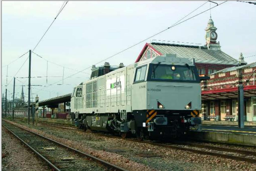
**PHOTO 84-50** *Le 25 janvier 2008, la G2000 VSTF 5001641 a effectué des parcours d'essais entre la gare de Mouscron (photo du milieu) et la gare de Tourcoing (photo du bas), afin de tester le bon fonctionnement de la transition de signalisation lors du passage de la frontière. Christian VANHECK.*
