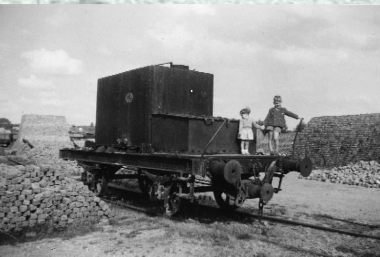
**Ce wagon des CUP portait une citerne à eau qui servait à ravitailler les machines à vapeur fixes réparties dans les différents bâtiments et installations. Ce véhicule à voie normale était pourvu des deux types de tampons et d'attelage.**
