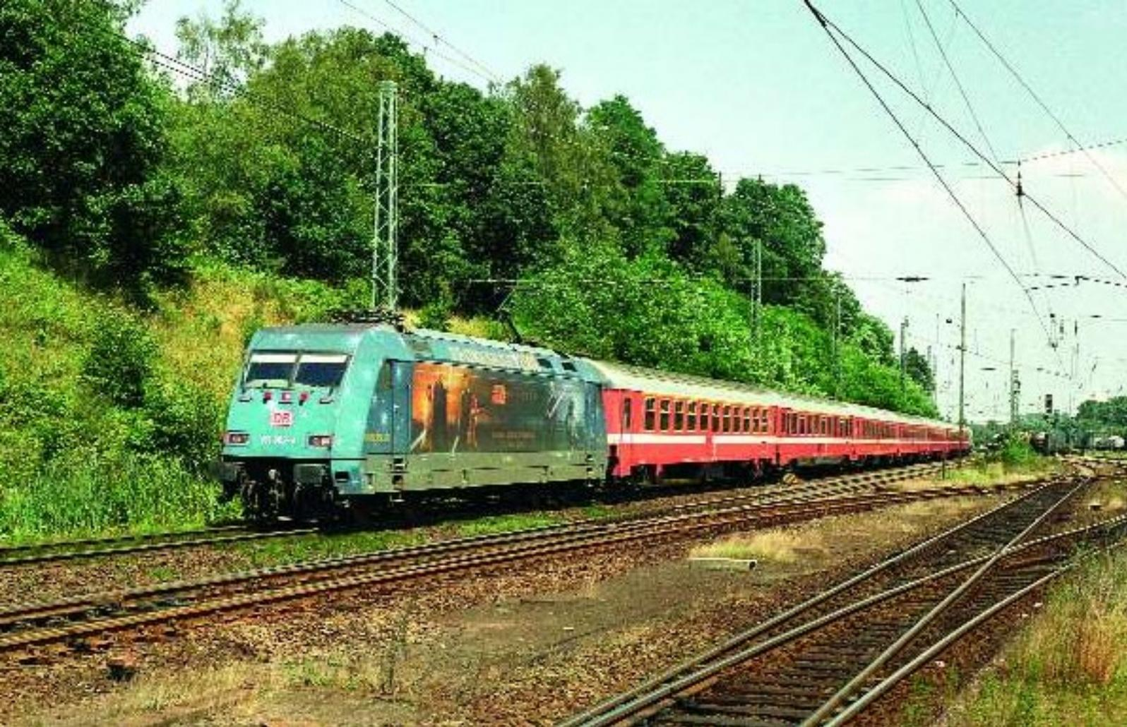
**PHOTO-THEME 84** *Passage à Stolberg Rheinland Hbf du train international D 424 Köln Hbf - Oostende, tracté par la 101 086-3 de la DB. Une locomotive de la série 27 prendra le relais à Aachen Hbf. La rame est composée de sept voitures, dont six I10, une I6 (en seconde position) et un fourgon DMS en queue.*
