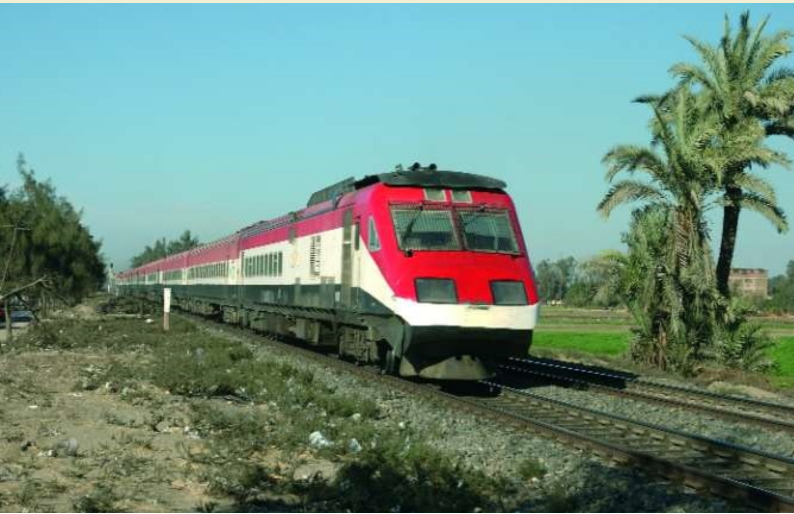
PHOTO 86-91 ↓ En 1983, les ENR mirent en service une série de 5 turbotrains construits par ANF-Industries en France, basés sur les RTG 2000 de la SNCF. Aujourd'hui, il ne subsiste plus qu'une seule rame en service, numérotée 6601, et repeinte aux couleurs nationales. Le 15 décembre 2007, ce turbotrain quitte Sidiyian vers Alexandrie. Thierry NICOLAS.
