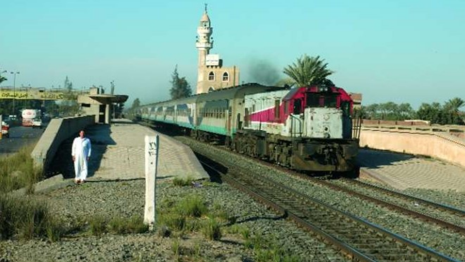
PHOTO 86-90 ↑ Le 15 décembre 2007, un train local quitte la gare de Sidiyian. En tête, la Co'Co' 2329, construite par General Electric (type GE C18-71). Yves STEENEBRUGGEN.
