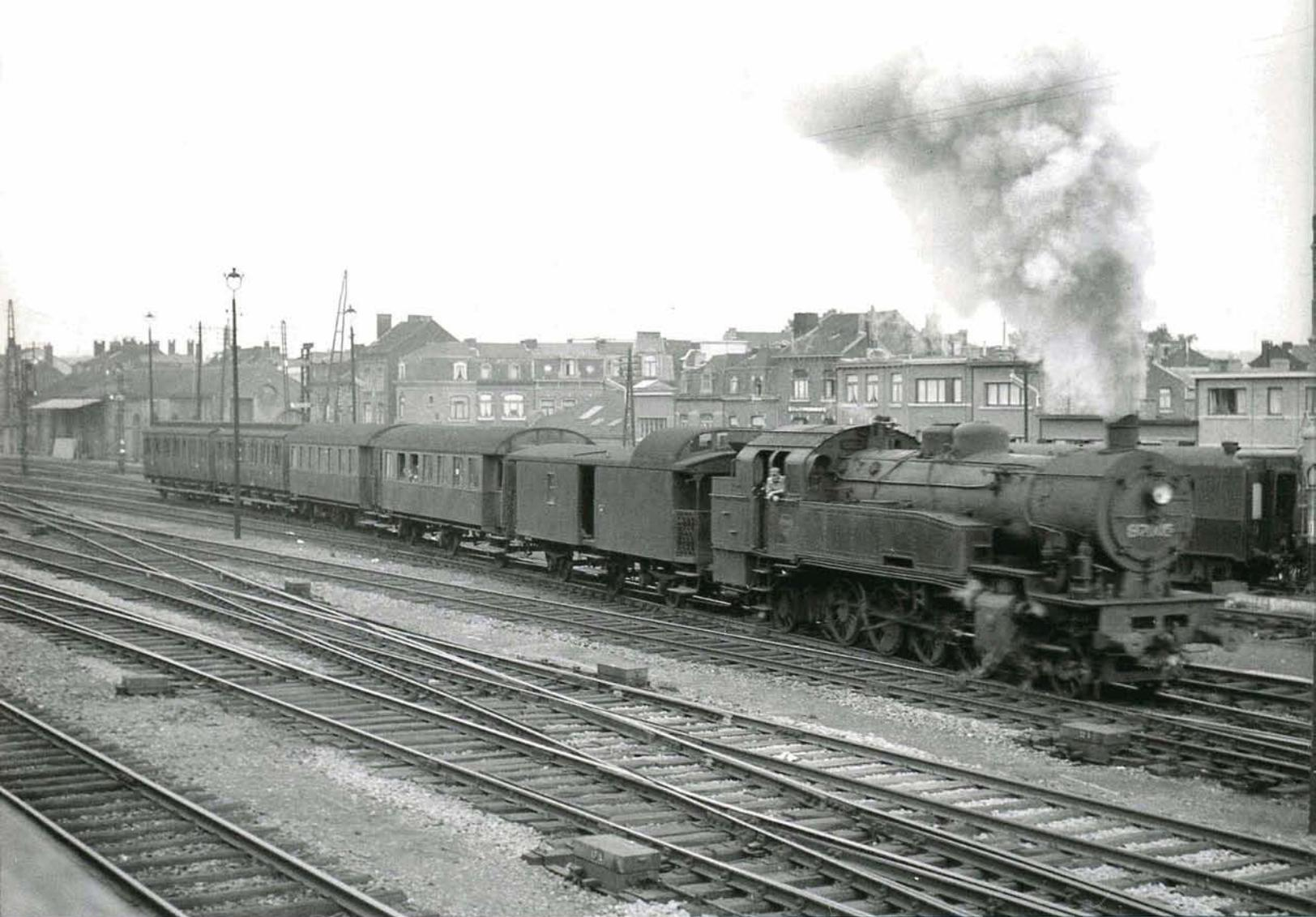
**PHOTO BD-289** Au début du mois d'août 1953, un train "Trottinette" quitte la gare de Liège-Guillemins, remorqué par la 97.005 (ex. 9705, ex. T14 KPEV 8508 Erfurt - constructeur Henschel 13540/1914). La rame est composée, dans l'ordre, d'un fourgon GCI, d'un couplage de voitures type T, et de deux autres voitures d'origine prussienne d'un type totalement différent. Les deux voitures type T sont d'origine bavaroise et arborent la livrée à deux tons de vert. Bruno DEDONCKER, collection PFT ©
