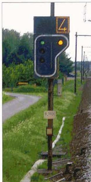
Ligne 35, bifurcation de Holsbeek. Le signal présente l'aspect vert et jaune horizontal. Le signal suivant est ouvert mais impose une réduction de vitesse à 40 km/h. Comme le chiffre est encadré, la vitesse est inférieure de plus de 30 km/h à la vitesse réduite la plus élevée pouvant être présentée.
