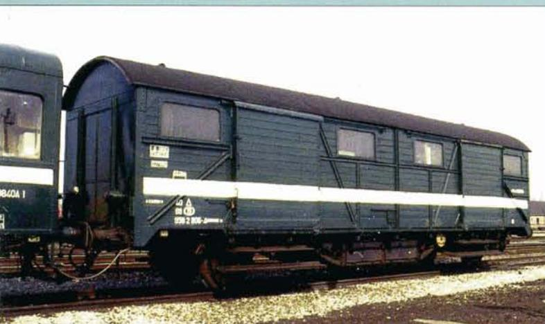
Plusieurs wagons furent réaffectés aux trains de relevage. Ici, celui de Hasselt (type 9582B8 - n° UIC 40 88 9582 806-4). C'est un wagon porte-auto de la seconde série (16 à 30) avec 2 portes sur les parois latérales. Des fenêtres ont été placées et les extrémités transformées. Hasselt, 15 avril 1984. Charles OCSINBERG.
