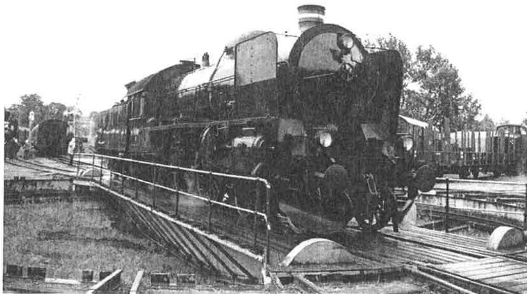
**La 946, locomotive à vapeur construite par SLM, sur le pont tournant du dépôt musée de Randers (DK)**
