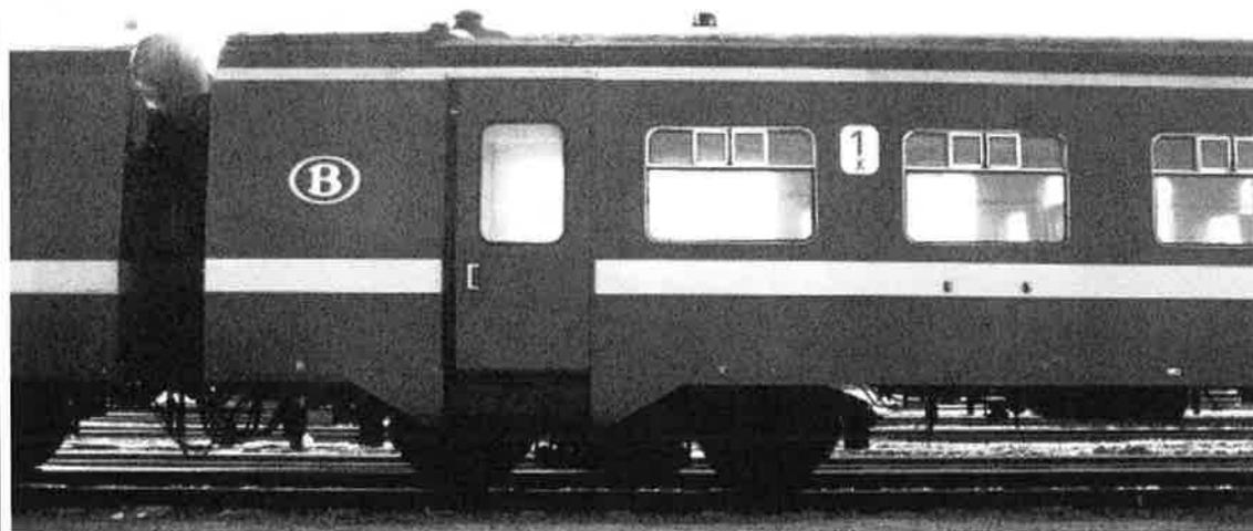
L'arrière de la première voiture. Il reste un pan après la dernière porte. Ce pan est formé d'une partie de 6 mm de la caisse d'origine et de 13mm de la partie en laiton avant le montant de porte.
