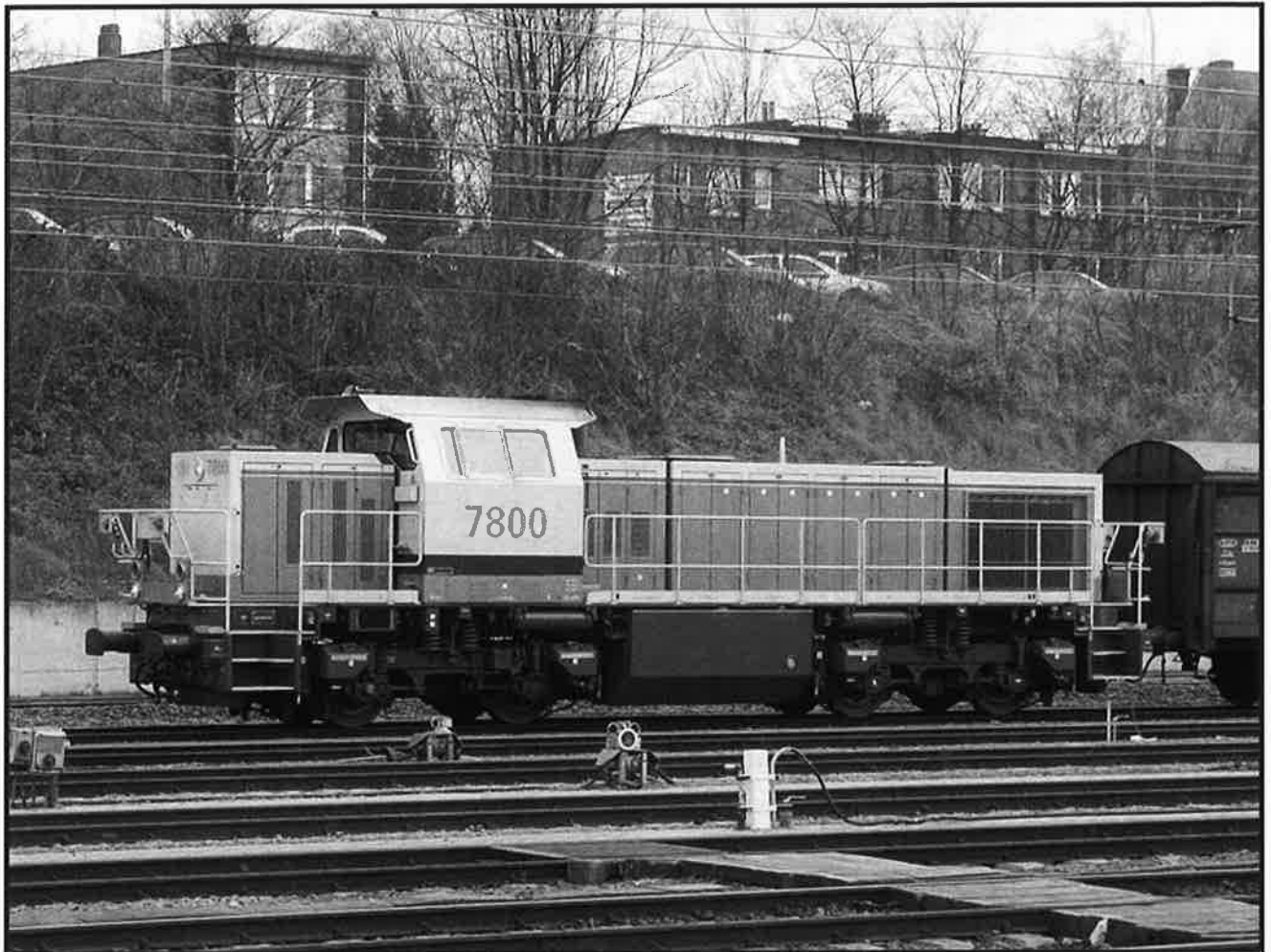
Première locomotive Diesel de la nouvelle série 77 portant un numéro dont les deux premiers chiffres sont "78" étant donné que cette série comporte plus de 100 exemplaires. On a déjà connu cette situation avec la série 62 dont une locomotive portait le numéro 6300. La 7800 remorque un convoi de marchandises en gare de Leuven, 29 décembre 2003 (photo Patrick Maes).
