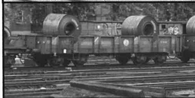
La motrice électrique n°1307 à Saint-Louis Voiture I2, Resto-bar Voiture I2 à toiture verte. Wagons Shmms, transport de coils
