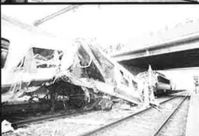
Accident SNCB à Izegem : défaut de signalisation.
