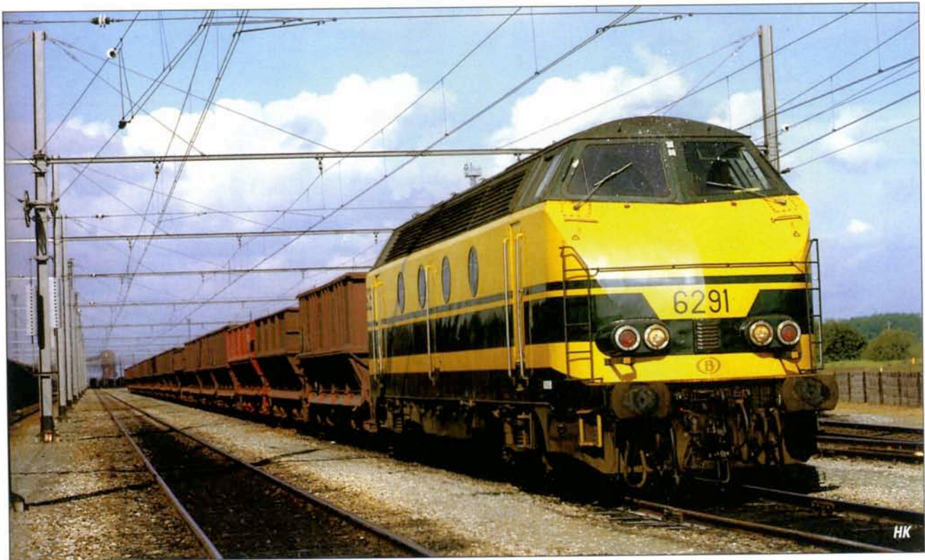
Autre exemple encore de caténaire simple sur transversaux. La caténaire compound, prévue — on le sait — pour permettre des vitesses élevées, ne se justifie aucunement sur un faisceau de garage et n'équipe donc que les voies principales.
