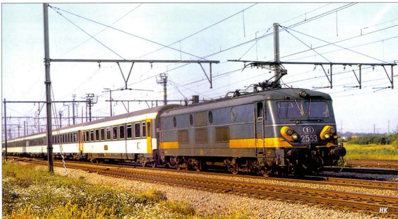
Amusante illustration d'une évolution en cours : la caténaire sous laquelle circule la 2553 était montée sur un transversal jusqu'à ce qu'on remplace celui-ci par le poinçon symétrique — utilisé en alignement — venu alors à la mode. Le poinçon qui maintenait le câble transversal en bout de console est toujours en place, mais sans emploi !
