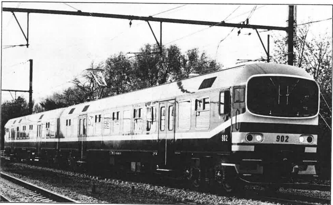
AUTOMOTRICE A HACHEURS 3 KV CC TYPE L 86 - SERIE 09 - 35 exemplaires : 901 à 935 (PHOTO SNCB)
