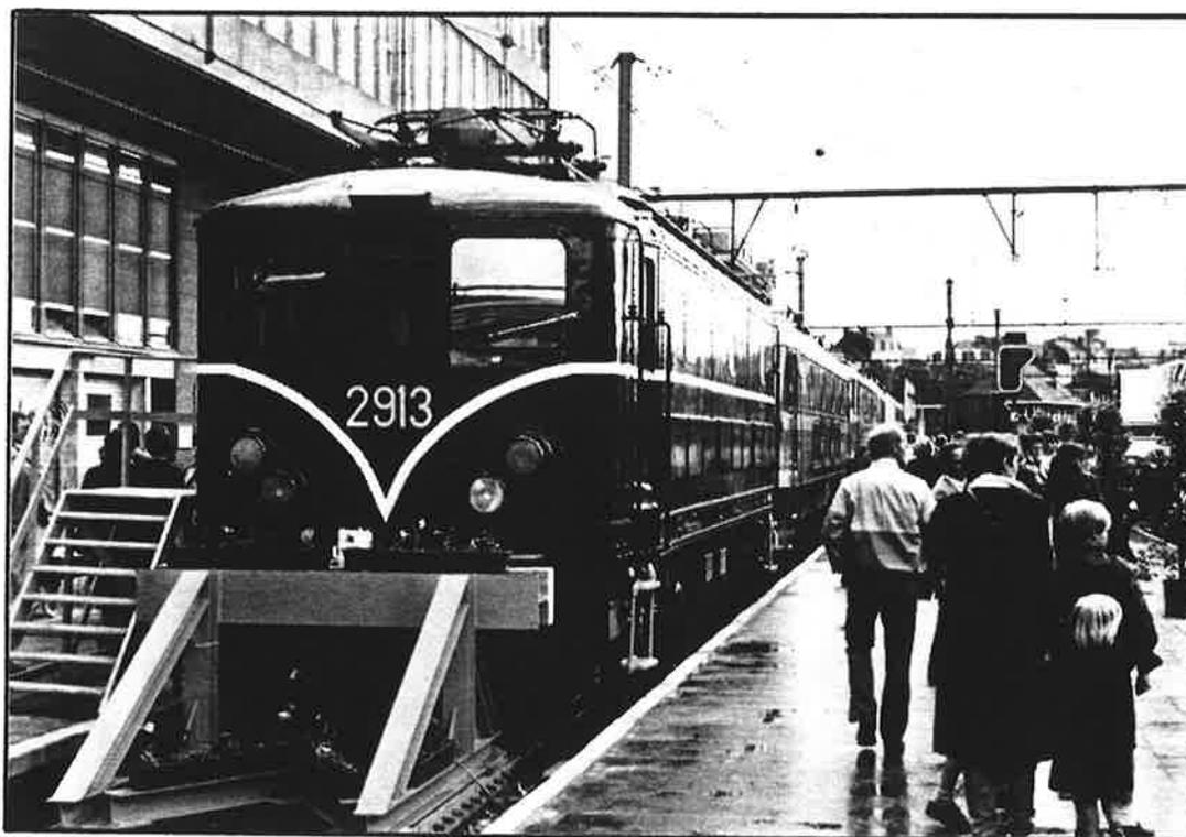
De 1973 à 1977, 10 locomotives sont transformées et l'on note le dédoublement de chaque phare (pour avoir le rouge et le blanc), la suppression des bandes jaunes de visibilité, le placement d'une ceinture de caisse chromée et le montage de lampes de double traction extérieures (jeux de 4 au dessus de la fenêtre centrale de chaque cabine de conduite, en remplacement des jeux anciens placés à l'intérieur derrière les fenêtres).
