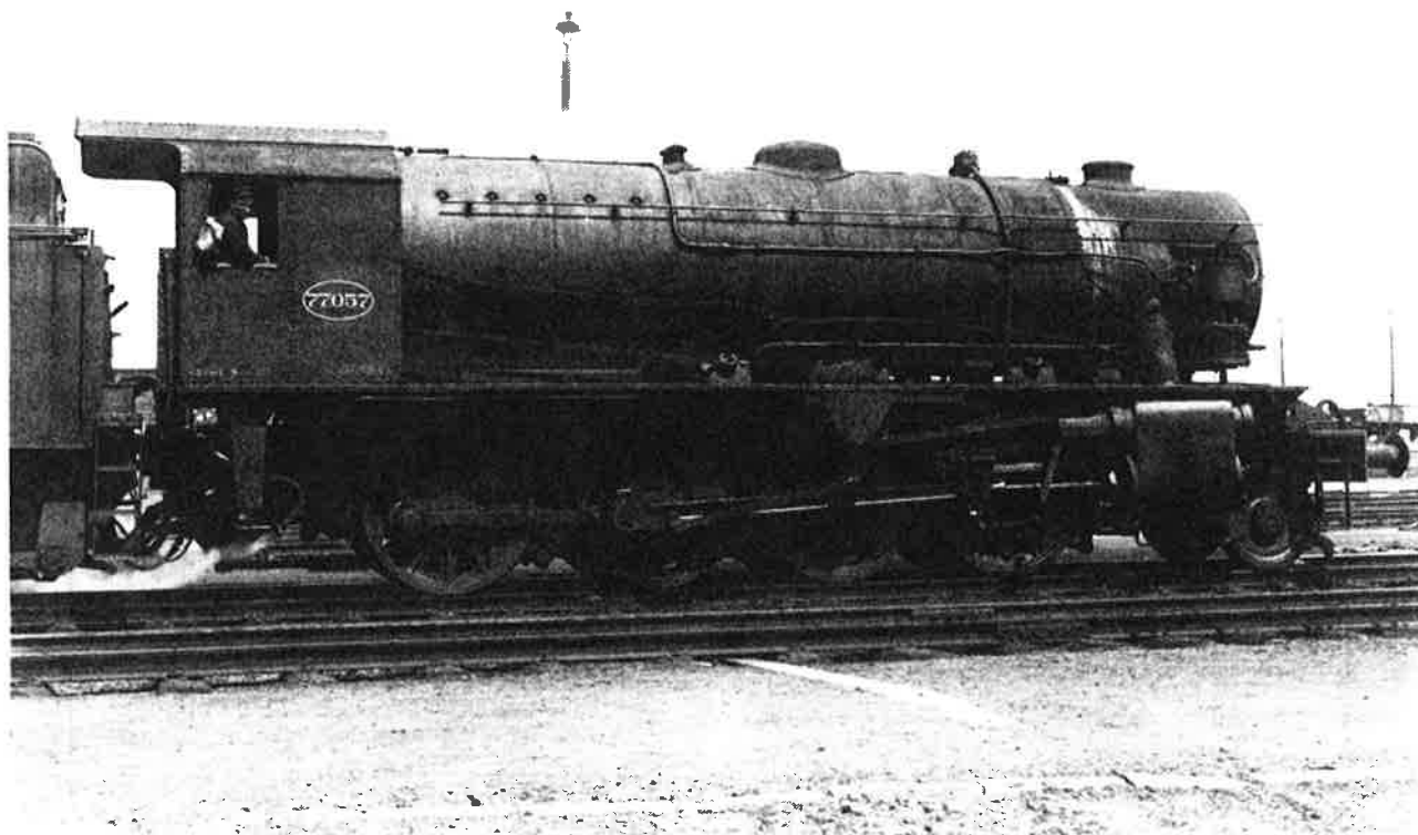
Locomotive 2-8-0 du "War Department" numéro 77057, affectée à la remise de Schaerbeek. Elle est sortie de moyenne réparation de C.W. Mechelen en juillet 1946, avec numéro appliqué avec pochoir SNCB. (Excès de zèle le point entre 77 et 057) (Photo Jean Quanjier, collection Phil Dambly)
