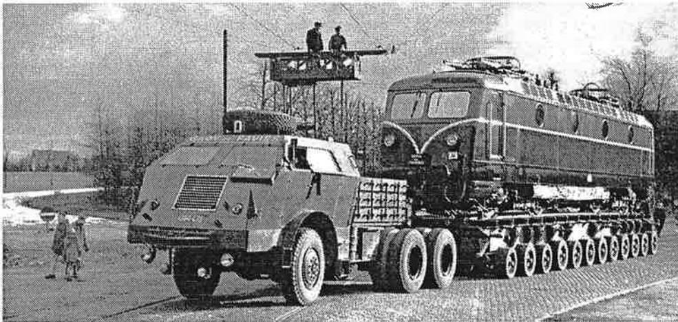
*La locomotive électrique n°122.038 de la SNCB passe sous la caténaire du tram, avenue du Sacré-Coeur. Les techniciens de la STIB soulèvent les fils pour permettre le passage des pantographes et des accessoires de toiture.*
