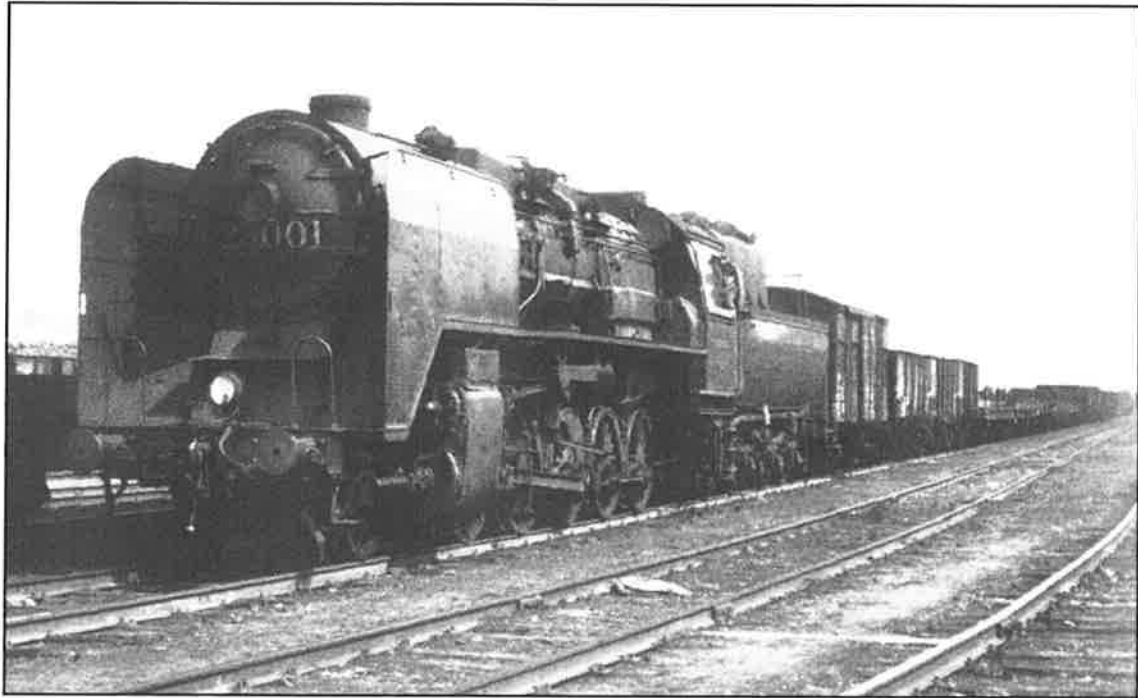
En tête d'un convoi de marchandises, la 25.001 avec ses pare-fumées et son tender "baignoire". Un phare électrique sur le tablier, 1 lanterne à pétrole sur la boîte à fumées. Athus, le 12 mai 1955 (photo parue dans "Vapeur en Belgique" tome 2 de Phil Dambly).
