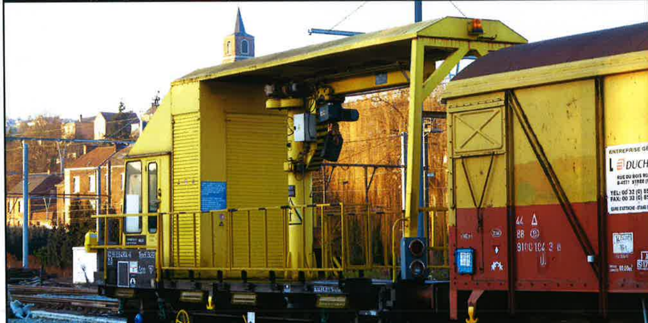
D'un côté du convoi, un véhicule avec portique grue et poste de pilotage n°40 88 953 4904-6 type 9534B2, un couvert n°44 88 9100 104-3 type 6931AO, un plat à ridelles n°80 88 393..., une grue "Grove" (marquée : "wagon Andre") n°99 88 03 11 001-9, la HLV 7844 d'Antwerpen n°92 88 0077 144-8B-BLX.
