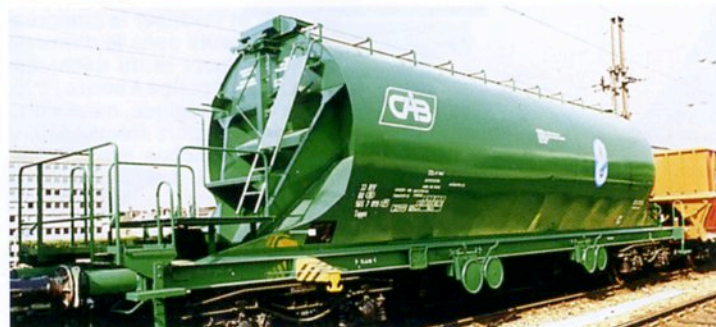
Wagon-trémie à toit basculant à déchargement central réglable (CAIB)
