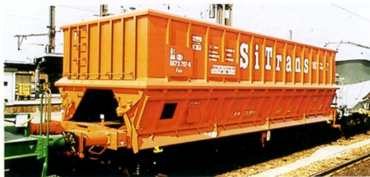
Wagon-trémie ouvert à déchargement bilatéral instantané (CAIB)
