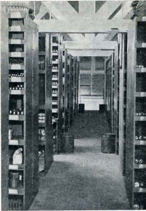
PHOTO 1. — Hauteur des rayons : maximum 2 mètres. Rayons disposés perpendiculairement à une large allée centrale ; A remarquer que les mesures préventives contre l'incendie n'ont pas été négligées.
