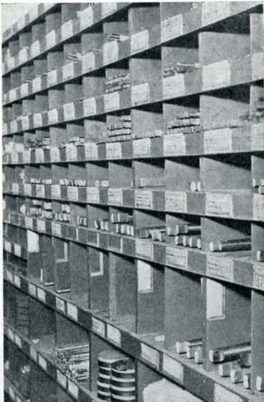
PHOTO 2. — Classement rationnel des articles dans des casiers standardisés. Identification des articles au moyen d'étiquettes de casier.
