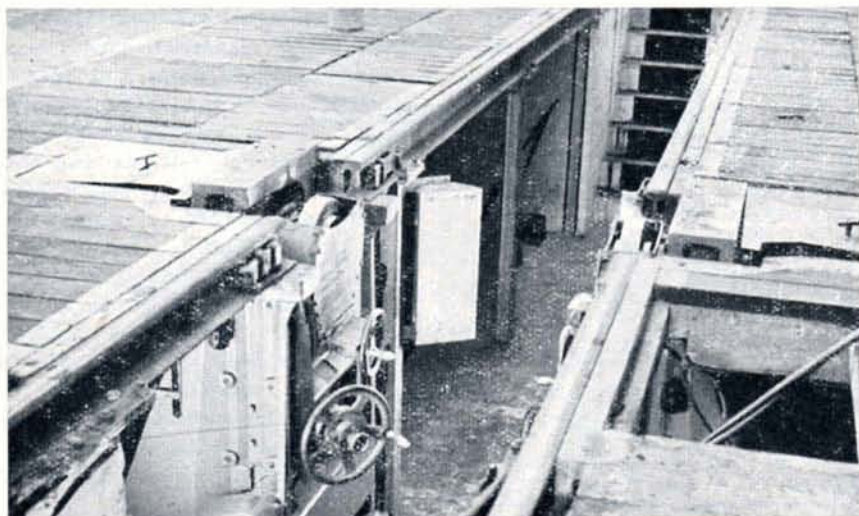
On distingue la meule à l'emplacement des tronçons de rail enlevés; pour rendre la photo plus suggestive, les deux supports qui soulèveront la caisse, ont été mis au point « haut ».
