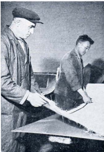
J. Renaert et M. Banken déroulent la fibre de verre et mesurent la longueur nécessaire à la fabrication d'un dôme d'autobus.
