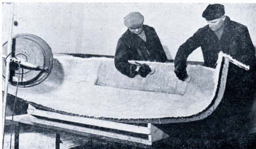
J. Dirix et W. Neven enduisent de résine de polyester la fibre de verre, par tamponnage. La partie gauche est terminée et est déjà en train de sécher sous les rayons d'une lampe chauffante.
